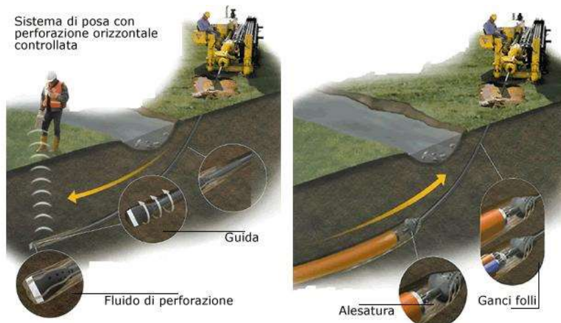
Posa in opera tubazione per alloggio cavi
