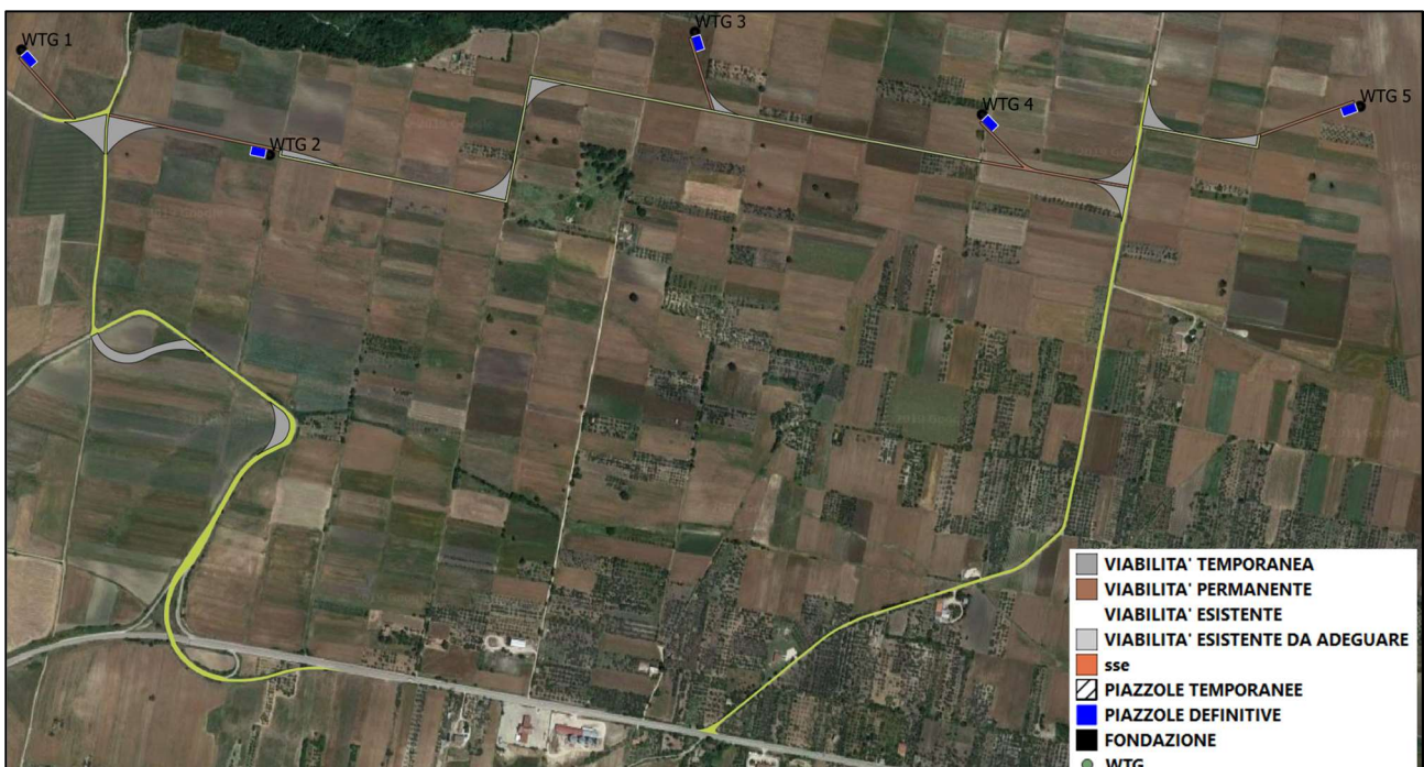
Stralcio viabilità di cantiere – WTG 1-5
