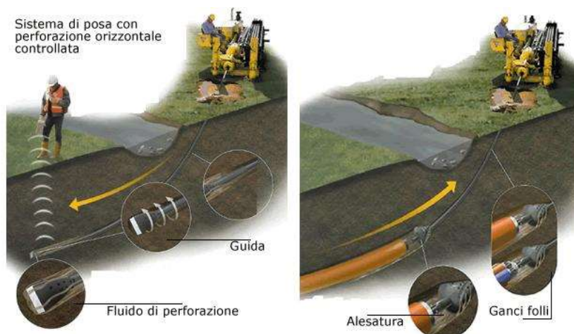
Posa in opera tubazione per alloggio cavi
