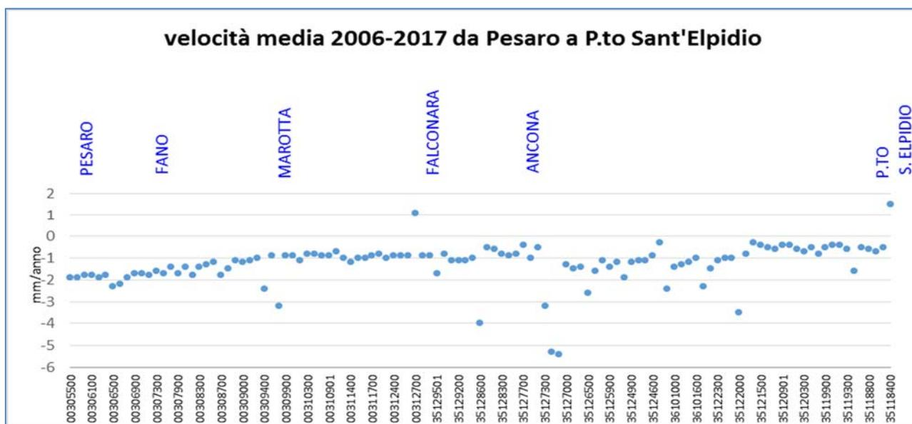
L'elaborazione con questo approccio delle misure di livellazione del periodo 2006-2017 mostra per l'area in esame, pur nell'ambito di un quadro di generale ma leggero abbassamento (Figura A), una marcata stabilità altimetrica a partire da Fano fino a P.to S. Giorgio: si consideri che il 93% dei punti analizzati ricade nella classe 1 con una media pari a 1.6 mm/a.
