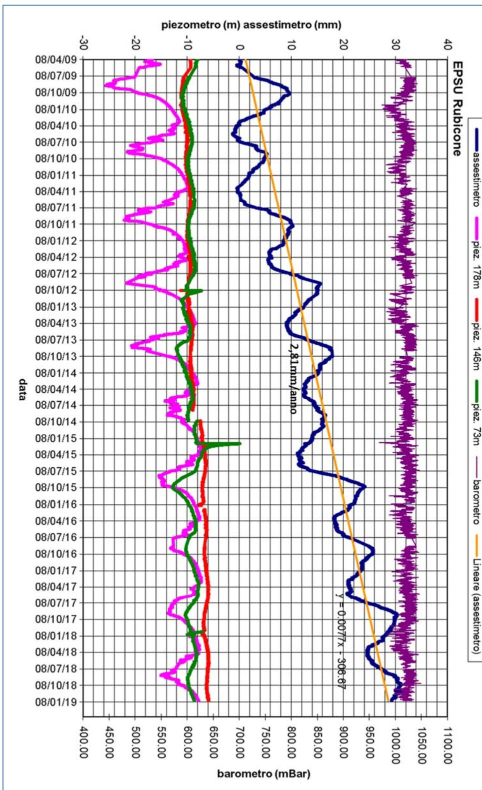
Figura 6B - Stazione EPSU di Rubicone: misure piezometrico-assestimetriche
