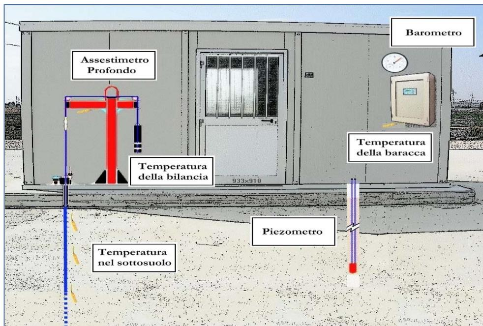
**Figura 2B - Rappresentazione schematica di una stazione EPSU**
