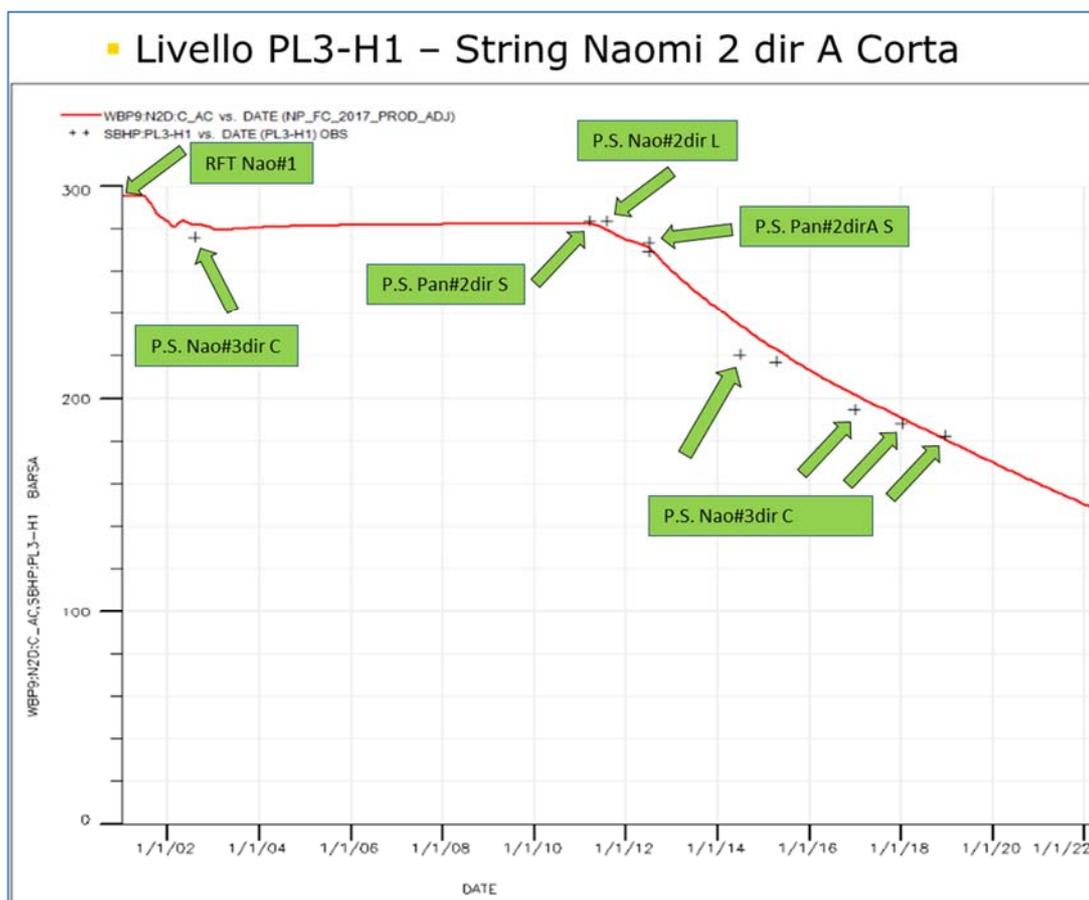
Figura 7 - Campo di Naomi-Pandora: pressioni statiche misurate e modello *Eclipse* 2017 (liv. PL3-H1)
