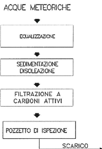
Schema di flusso impianto di trattamento
