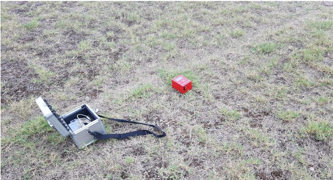
I dati sperimentali ricavati dalle indagini di sismica passiva a stazione singola permettono di ricavare una stima delle velocità delle onde di taglio  $V_s$ .
