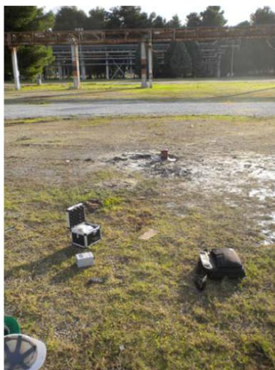
Foto 1. Disposizione sul terreno dell’acquisitore sismico durante l’effettuazione del sondaggio Tr1 (in secondo piano si individua il bocca pozzo del sondaggio meccanico S1)
