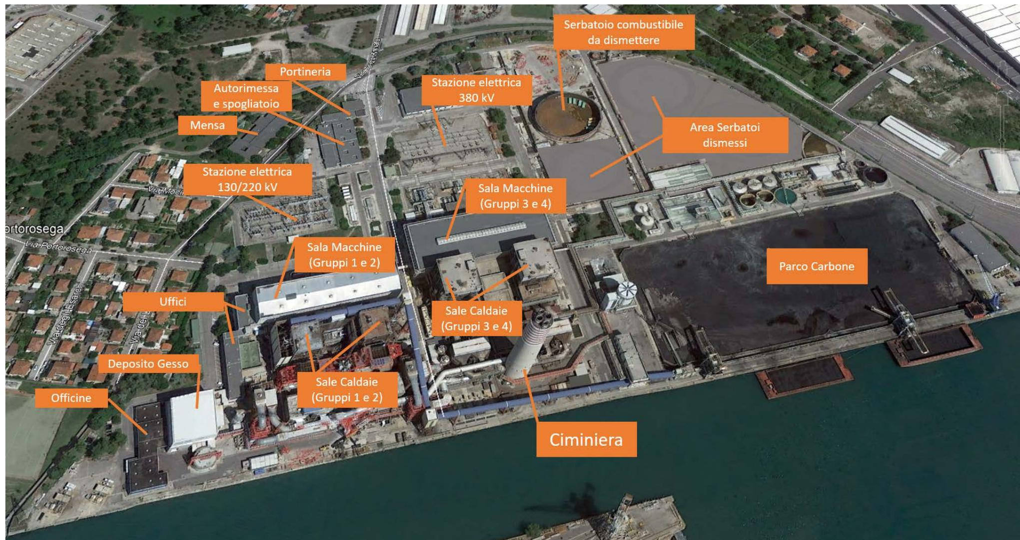
Figura 2-19: Panoramica della Centrale Termoelettrica di Monfalcone (Fonte: Google Earth PRO) ed individuazione dei principali edifici e settori
