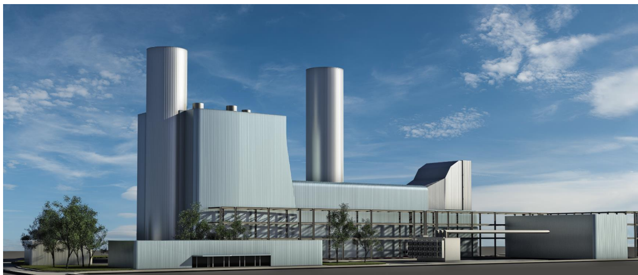
Figura 13: Modello 3d dell'impianto - Vista prospettica da N ( in primo piano l'edificio Amministrazione e Controllo; a sinistra l'edificio trattamento gas; al centro il Trasformatore elevatore TG; a destra l'Edificio Quadri elettrici. In secondo piano il complesso dell'Isola di potenza, con (da sx a dx) il Camino principale (Camino GVR), il fabbricato di rivestimento del Generatore di vapore a recupero (GVR), il corpo più basso dell'edificio Sala macchine TG prolungato fino al GVR, dal quale spunta il Camino di Bypass; infine il Filtro di aspirazione TG. Si notano le strutture metalliche dei rack di supporto delle tubazioni di collegamento con la Turbina a vapore (localizzata all'interno della sala macchine dell'esistente gruppo 4, da tempo dismessa).
