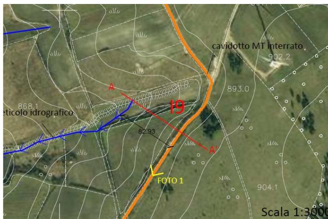
**Figura 24** - individuazione parallelismo del reticolo idrografico con cavidotto MT interrato con rappresentazione della distanza planimetrica dello stesso dal reticolo idrografico e traccia della sezione A-A'
