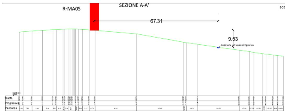
Figura 9 – Sezione A-A' dalla quale è possibile notare che le opere in progetto dista 67,31 m dal reticolo idrografico con una differenza di quota di 9,53 m
