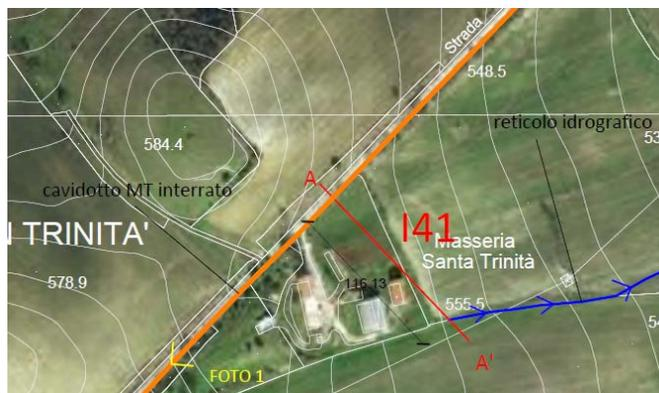
**Figura 78** - individuazione parallelismo del reticolo idrografico con cavidotto interrato
