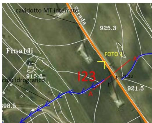
Figura 46 - individuazione parallelismo del reticolo idrografico con cavidotto interrato
