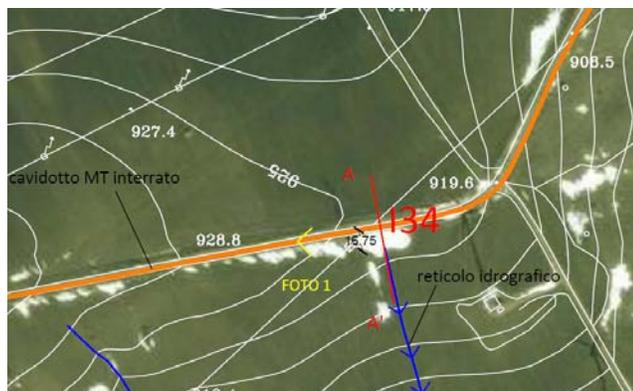
Figura 64 - individuazione parallelismo del reticolo idrografico con cavidotto interrato
