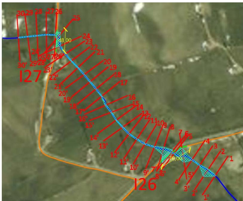
**Figura 52** - individuazione dell'interferenza del reticolo idrografico con la strada esistente e il cavidotto MT interrato e rappresentazione delle aree allagabili determinate con Tr200anni. In verde il tratto di cavidotto da eseguire con TOC.
