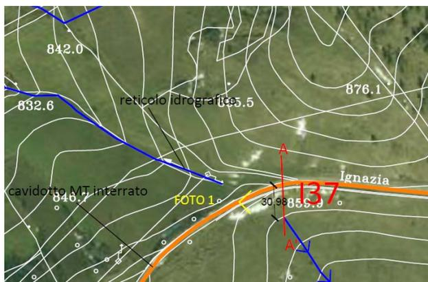
Figura 70 - individuazione parallelismo del reticolo idrografico con cavidotto interrato
