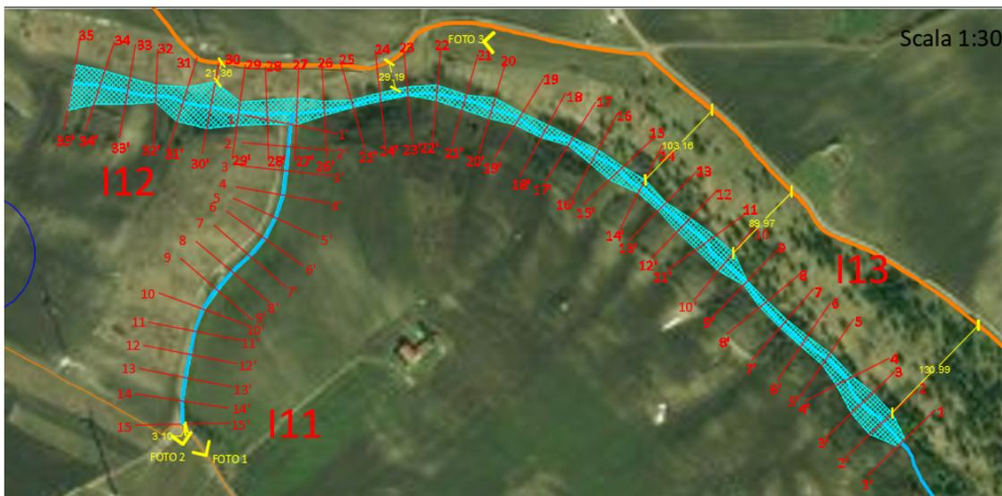
**Figura 28** - Individuazione dell'area allagabile del reticolo idrografico I11-I12-I13 calcolata con  $T_r=200$ anni e indicazione della distanza dall'area allagabile e le opere in progetto
