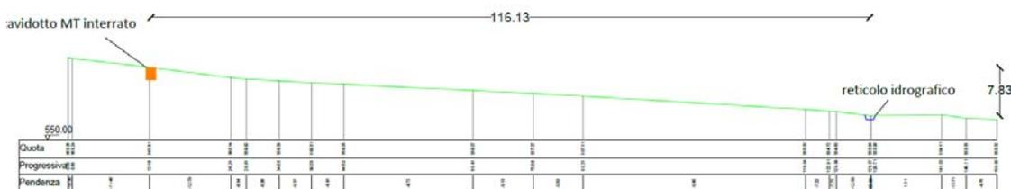
**Figura 79** – Sezione A-A' dalla quale è possibile notare che le opere in progetto distano 116,13 m dal reticolo idrografico con una differenza di quota di 7,83 m
