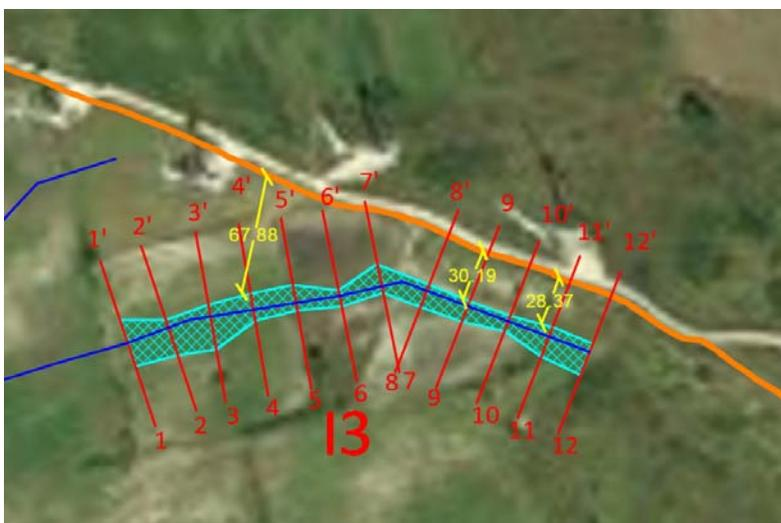
**Figura 12** - Individuazione dell'area allagabile del reticolo idrografico I3 calcolata con  $T_r=200$ anni e indicazione della distanza dell'area allagabile e le opere in progetto
