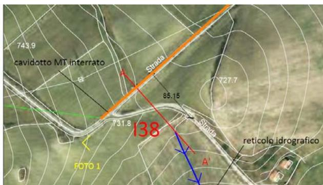
**Figura 72** - individuazione parallelismo del reticolo idrografico con cavidotto interrato
