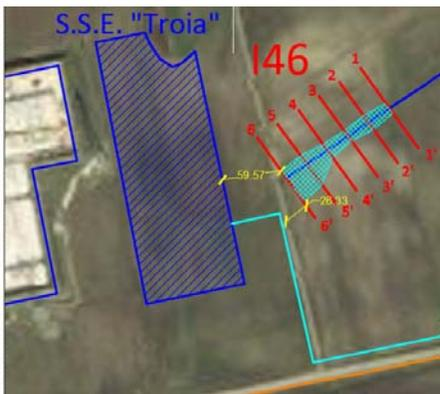
**Figura 87** - Individuazione dell'area allagabile del reticolo idrografico I46 calcolata con  $T_r=200$ anni e indicazione della distanza dall'area allagabile e le opere in progetto
