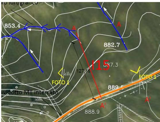
Figura 31 - individuazione parallelismo del reticolo idrografico con cavidotto interrato
