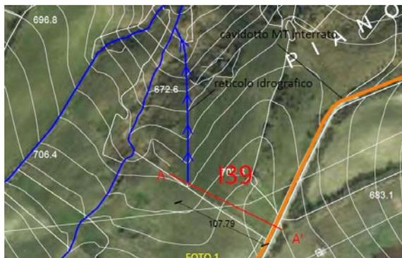
Figura 74 - individuazione parallelismo del reticolo idrografico con cavidotto interrato
