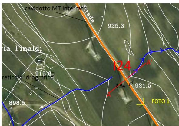
Figura 48 - individuazione parallelismo del reticolo idrografico con cavidotto interrato
