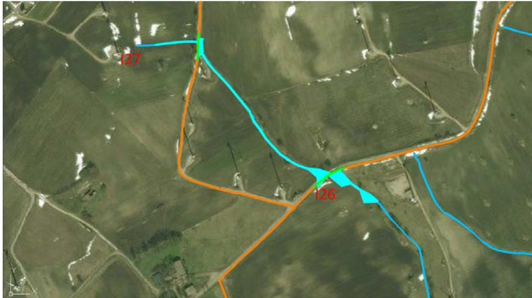
Figura 12- Tratto di cavidotto da realizzare in TOC N.5-6 in corrispondenza di aree allagabili.
