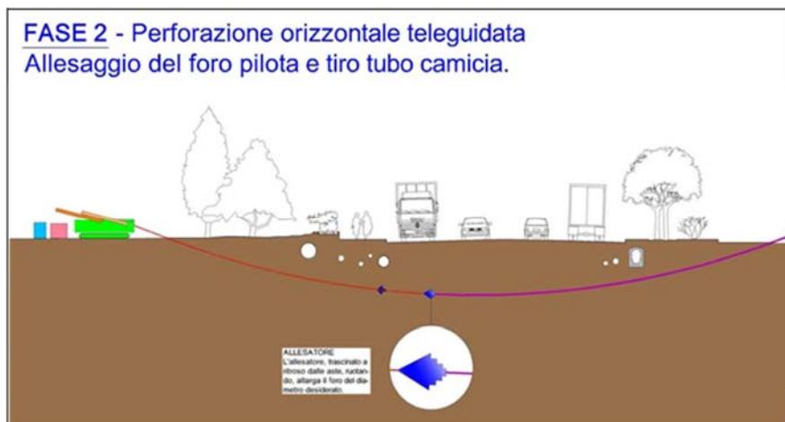
Figura 6- Schema perforazione teleguidata
