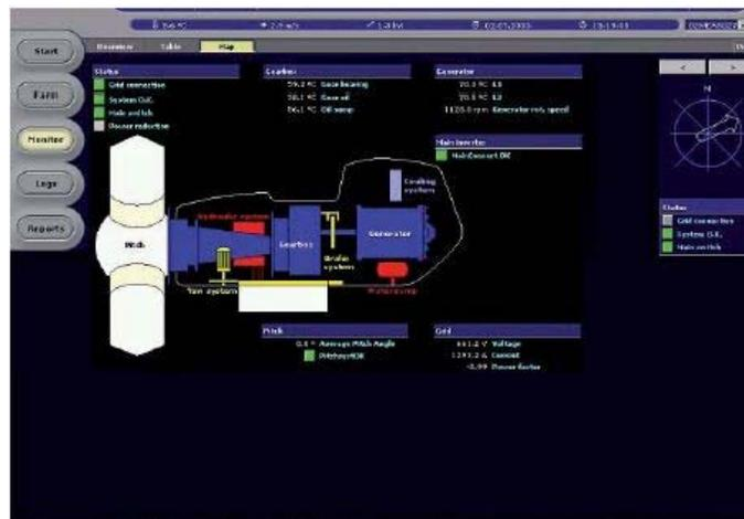
Figura 6 - Schermata di controllo del monitoraggio remoto di una turbina
