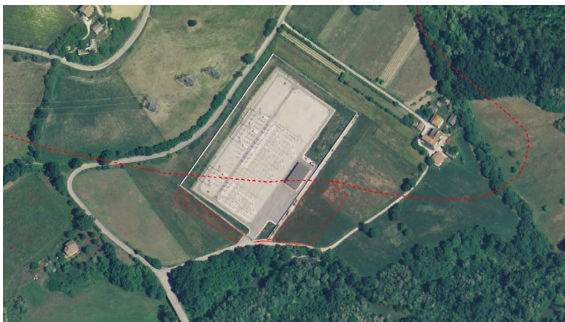
Figura 2.3.2 – Superfici interessate dall'ampliamento della SE di Teramo (aree in rosso) all'interno del SIC (linea tratteggiata rossa).
