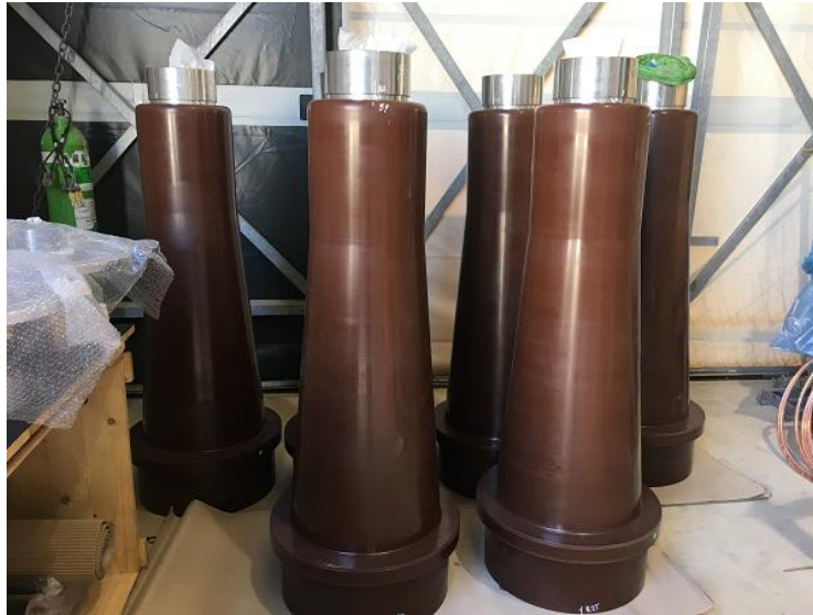
Figura 53 – Particolare terminale cavo
