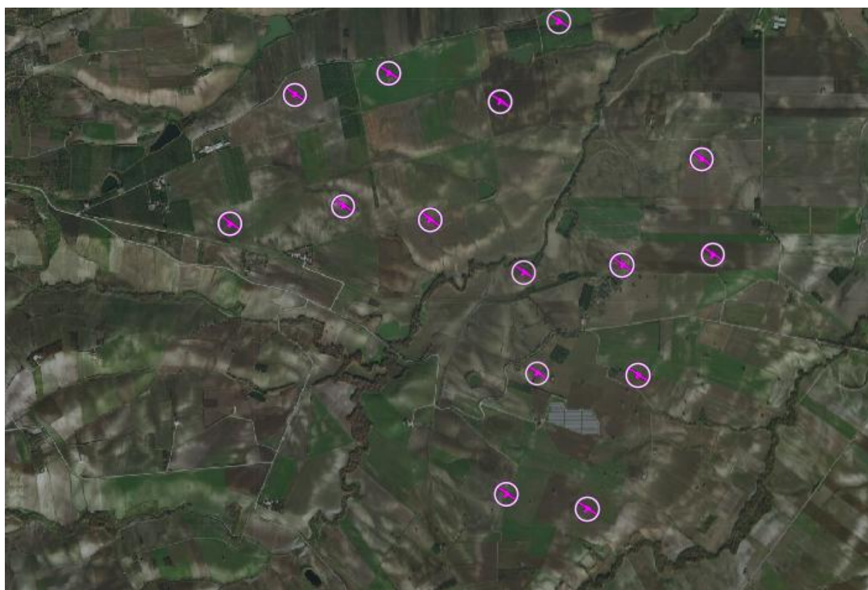
Figura 3 - Ipotesi di layout a 15 aerogeneratori
