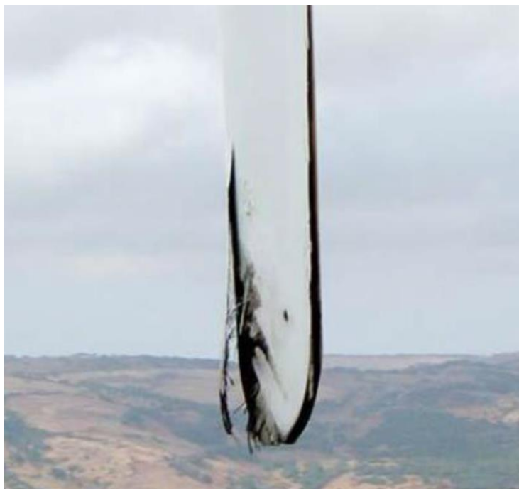
Figura 1 - Estremità della pala danneggiata da fulminazione atmosferica
