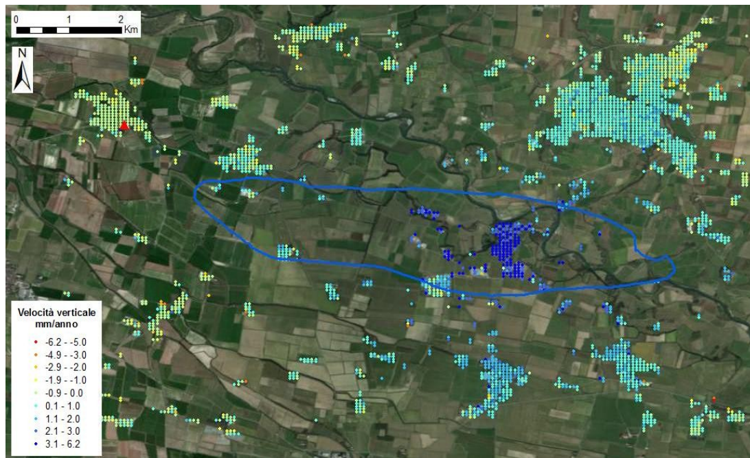
Figura 3 – Riproduzione della Figura 33 del rapporto di monitoraggio dei movimenti del suolo dello stoccaggio di Bordolano per l'anno 2018 (STOGIT, 2019b). Visualizzazione in scala di colori delle velocità verticali dei punti scomposti dell'analisi Local.
