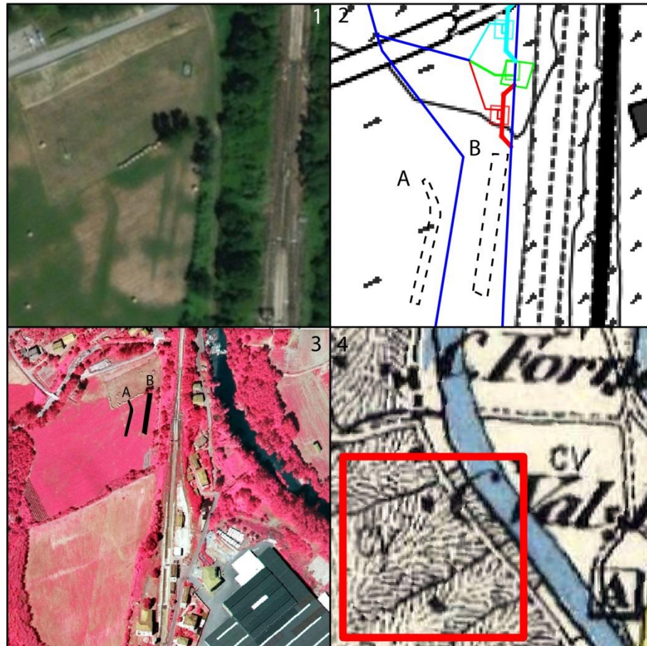
Figura 6: 1- Ortofotografia a colori reali, 2- Catasto, tracciato metanodotto e interpretazione delle tracce presenti nella vegetazione, 3. Ortofotografia ad infrarosso, 4- Cartografia storica con indicazione dell'area interessata dalla presenza di cropmarks.
