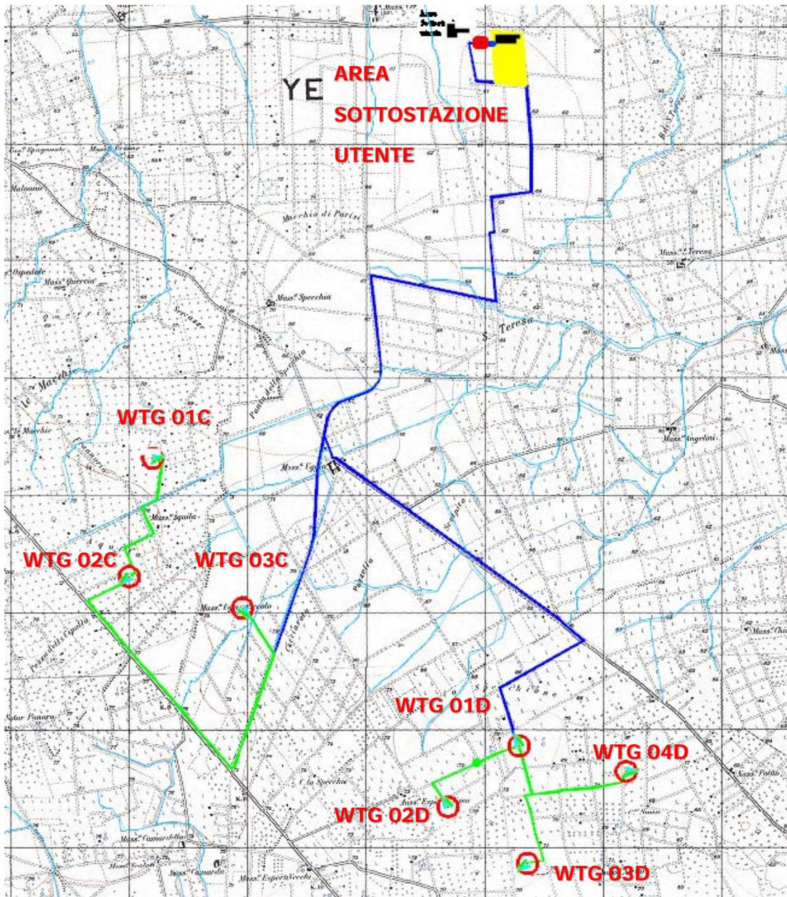
Figure 2-Planimetria di progetto su base IGM 1:25.000
