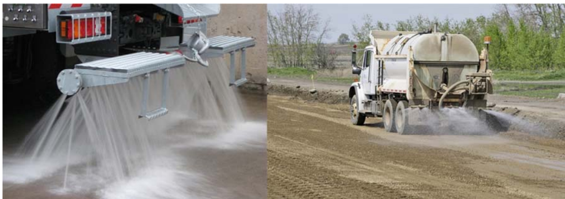
Figura 4-1: Automezzo per la bagnatura delle piste sterrate
