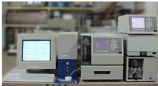
TIPO DI STRUMENTO: **Cromatografo per cromatografia liquida ad alte pressioni (HPLC).**
