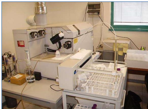
**A1- VII Analisi del Silicio - Spettrofotometro a emissione atomica ICP-AES Vista-MPX**
