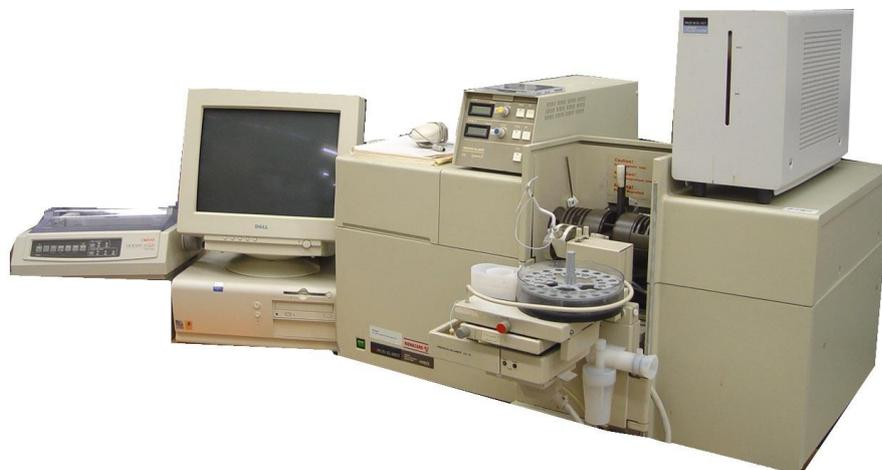
TIPO DI STRUMENTO: Spettrofotometro ad assorbimento atomico a doppio raggio con
