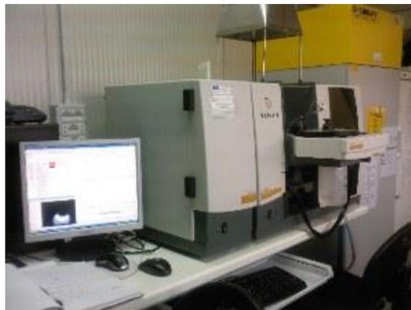
**A2-X      VARIAN ICP-720ES per la misurazione di ALLUMINIO, BARIO, FERRO, CROMO, NICHEL, RAME, SILICIO, VANADIO e ZINCO**
