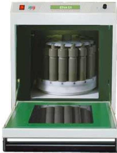
TIPO DI STRUMENTO: Forno **Mineralizzatore /estrattore**
