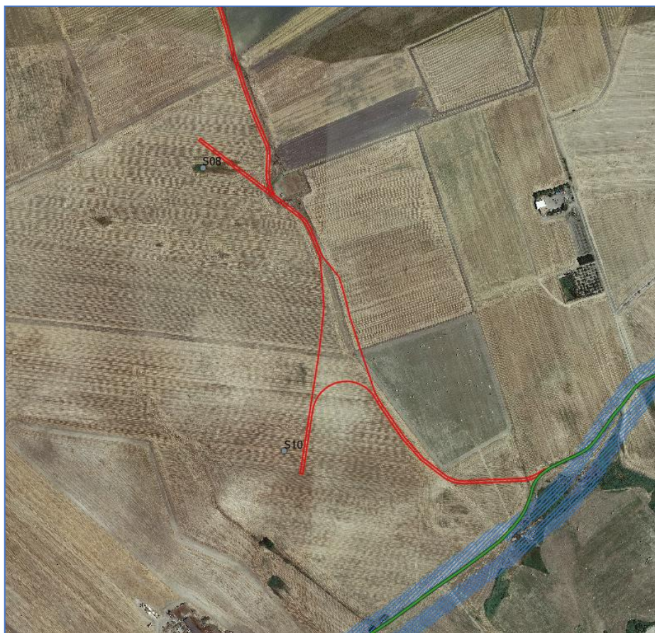
Figura 3 - raccordo temporaneo per l'accesso alle torri S08- S09- S10
