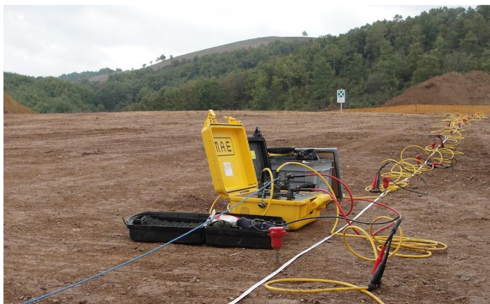
Figura 3 - Indagine sismica - Down Hole
