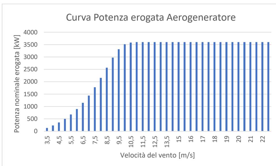
I valori della potenza in uscita e del coefficiente di spinta garantiti dal costruttore in funzione della velocità media del vento all'altezza del mozzo e per una densità dell'aria pari a 1,225 Kg/m<sup>3</sup> sono i seguenti:
