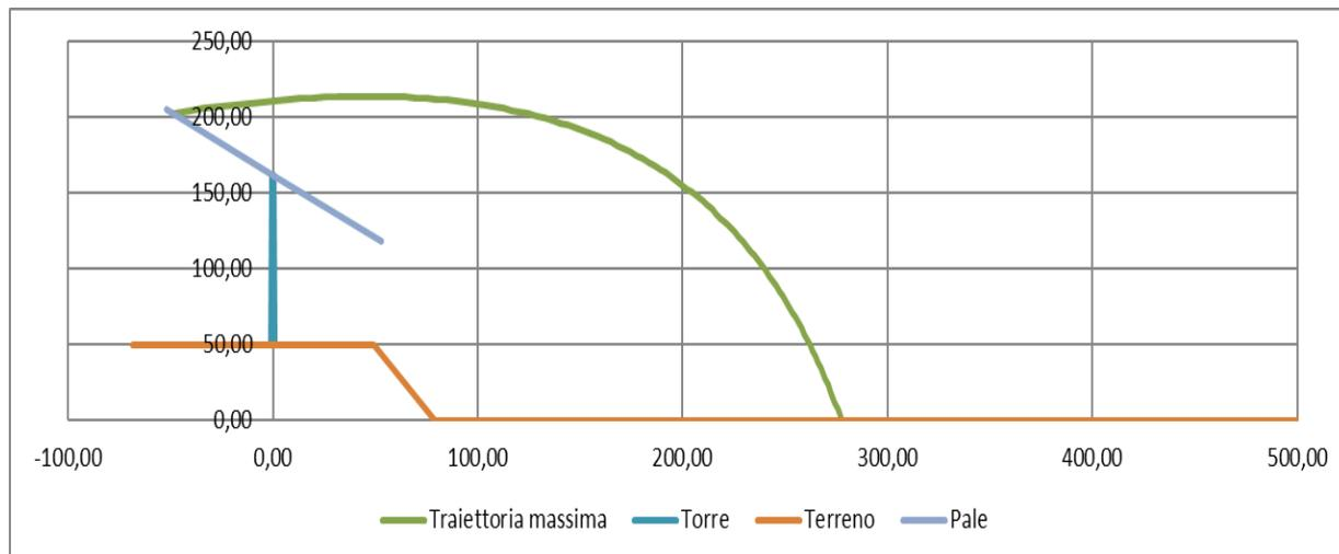
Figura 5 - Traiettoria del moto di un frammento di 10 m, a seguito di rottura
