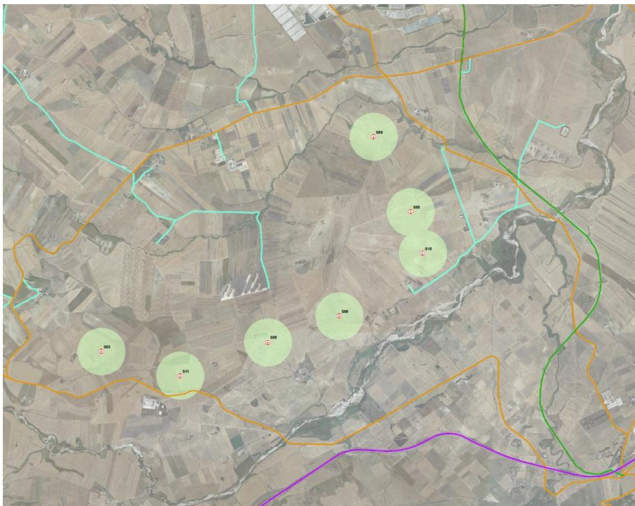
Tale distanza, ovvero 230 m, che è la minima, tra tutti gli aerogeneratori e una strada, risulta essere paragonabile (data la minima differenza di appena 70 m) alla distanza massima raggiunta dagli elementi rotanti in caso di rottura accidentale, pari a circa a 300 m in via cautelativa, così come calcolata nell'elaborato "VWS-AMB-REL-043 - Gittata massima degli elementi rotanti".
