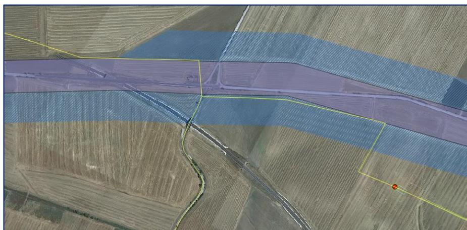
**Fig. 3-15: Attraversamento in toc del cavidotto (in giallo) sul tratturo agro di Spinazzola (bat)**
