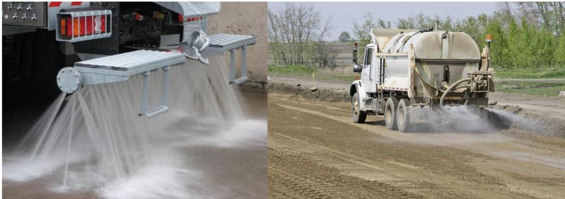
**Figura 6-44: Automezzo per la bagnatura delle piste sterrate**
