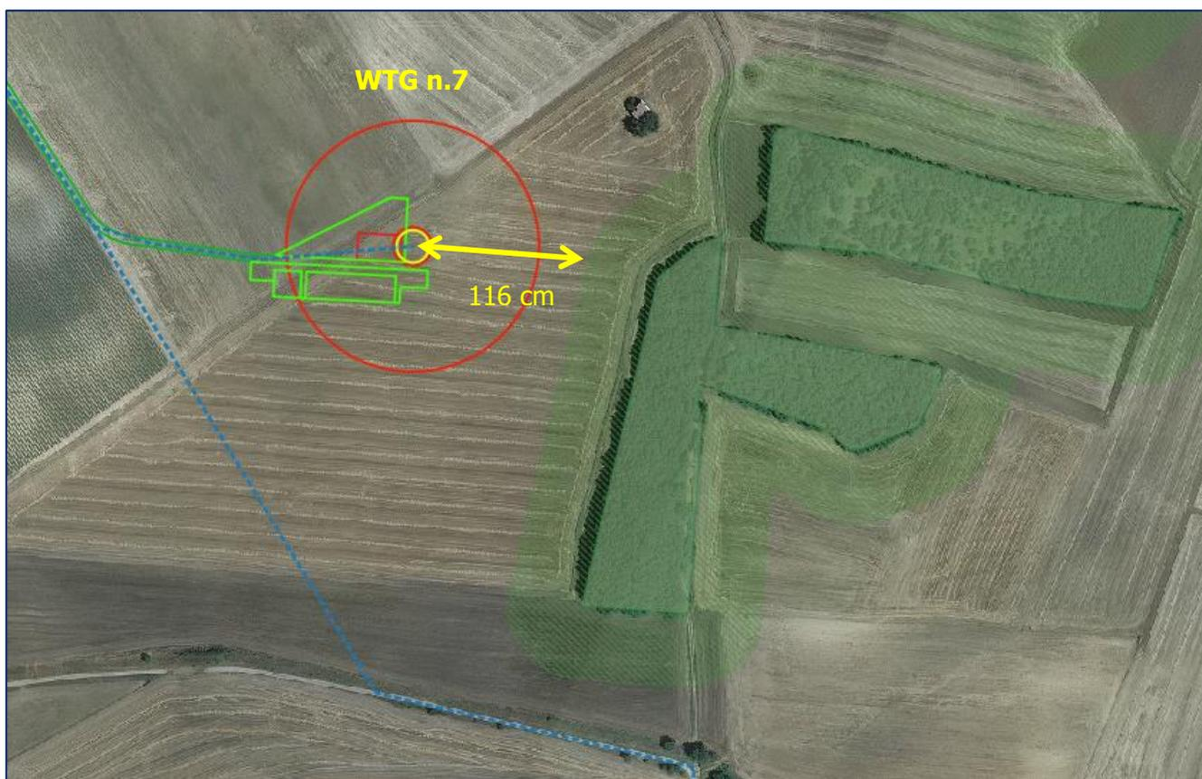
**Fig. 13-3: distanza della WTG n.7 dall'area di rispetto del bosco**
