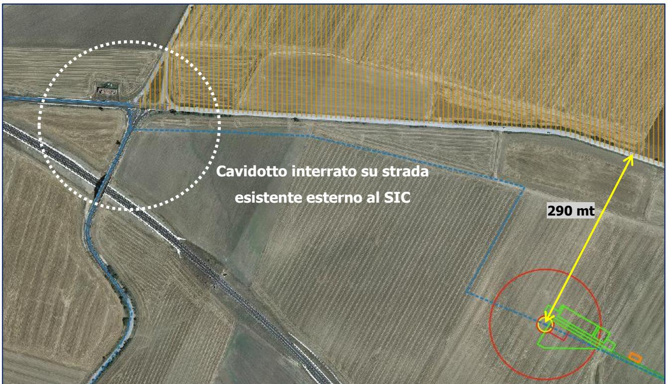
**Fig. 13-6: particolare del tracciato del cavidotto e della WTG n. 9 in relazione al SIC IT9150041**
