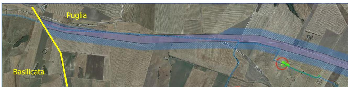
**Fig. 13-7: Sovrapposizione del cavidotto al tratturo nei confini della Puglia**
