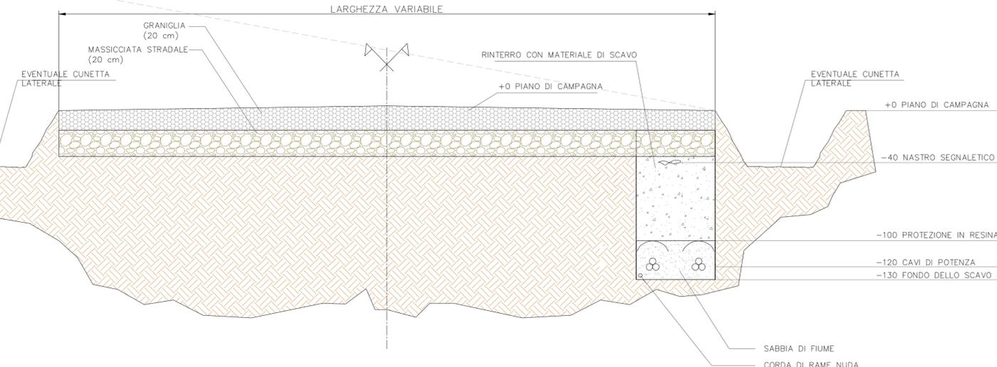
SEZIONE DI SCAVO TIPO SU STRADA PUBBLICA ASFALTATA TERNA DI CAVI MT IN BANCHINA
