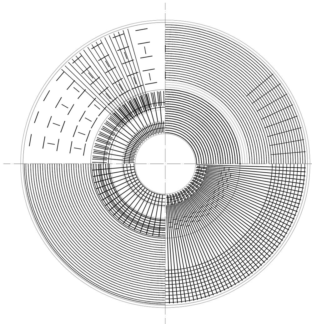
**SEZIONE A-A ARMATURA TIPO FONDAZIONE SU PALI**
