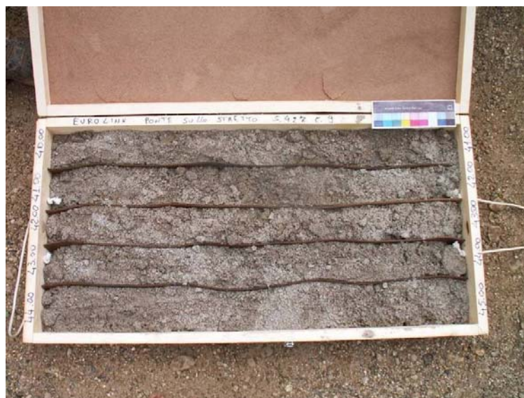
Figura 5 - Livello a bassa cementazione all'interno della formazione delle Ghiaie e sabbie di Messina.
