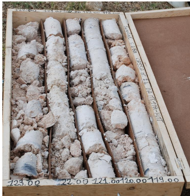
Figura 6 - Aspetto del calcare vacuolare, nel sondaggio S 450.
