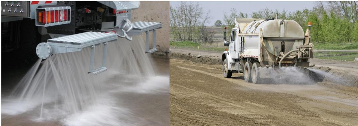
**Figura 2-54: Automezzo per la bagnatura delle piste sterrate**
