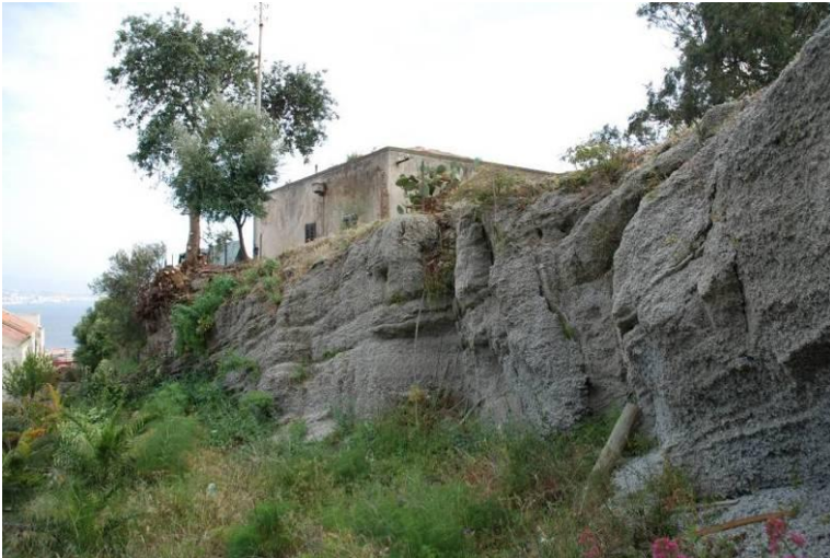
Figura 14 - Formazione delle Ghiaie e sabbie di Messina, costituita da banconi conglomeratici cementati di spessore decimetrico-metrico. Loc.: Pantano grande, Ganzirri.
