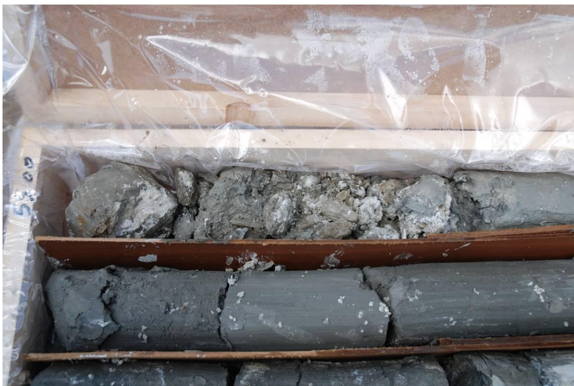
Figura 5 – Sondaggio S 452: particolare della argille gessose in cui prevale il gesso.
