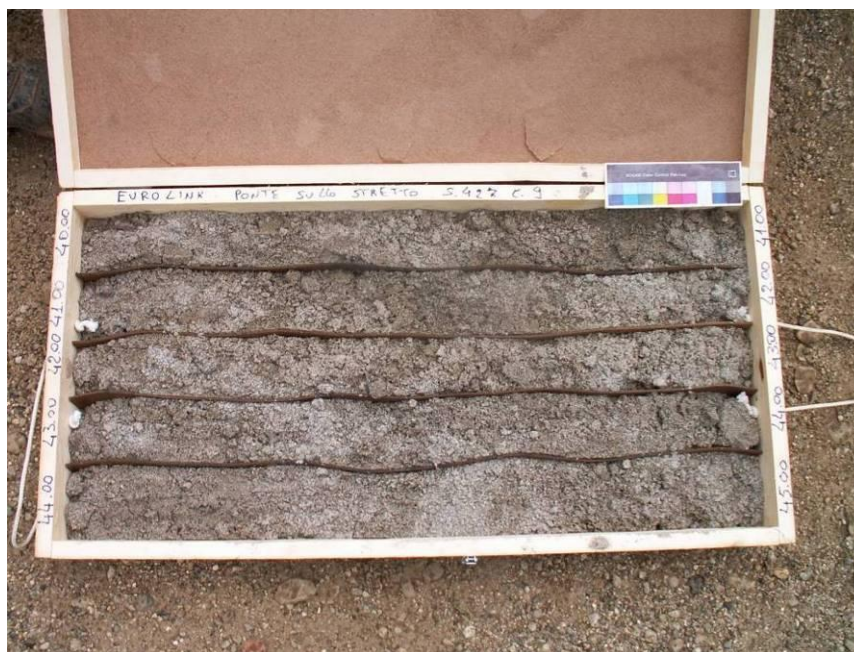
Figura 26 - Livello a bassa cementazione all'interno della formazione delle Ghiaie e sabbie di Messina.
