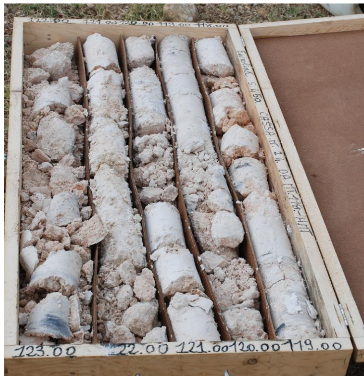
Figura 8 - Aspetto del calcare vacuolare, nel sondaggio S 450.
