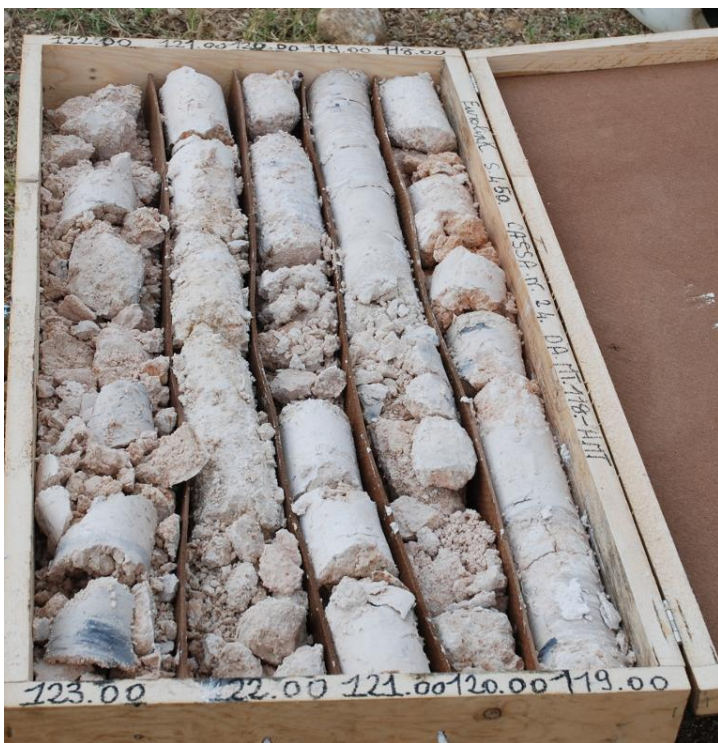
Figura 29 - Aspetto del calcare vacuolare, nel sondaggio S 450.
