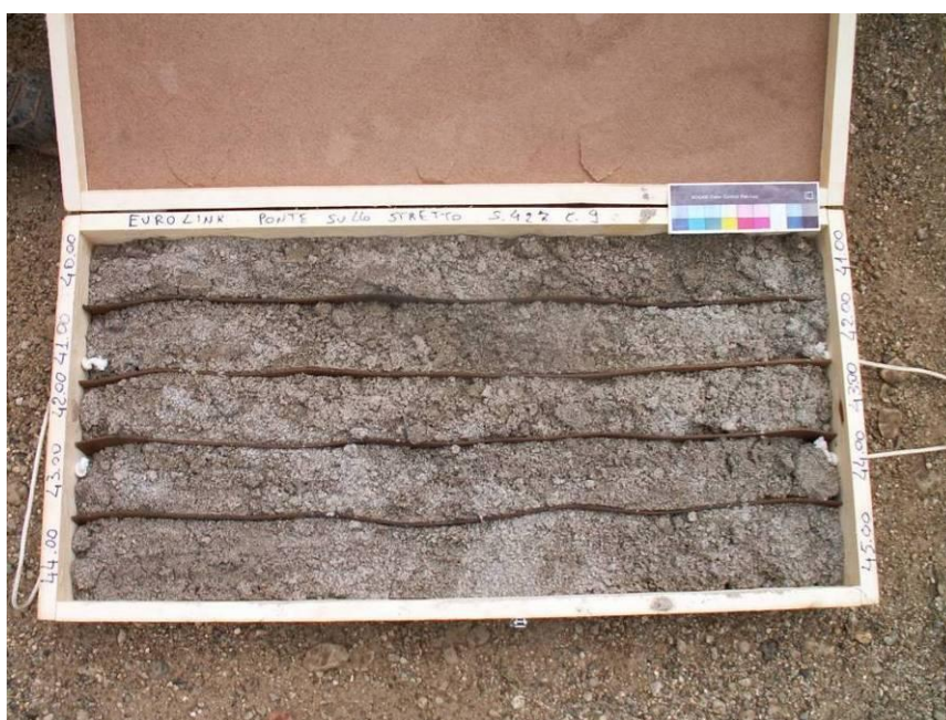
Figura 22 - Livello a bassa cementazione all'interno della formazione delle Ghiaie e sabbie di Messina.
