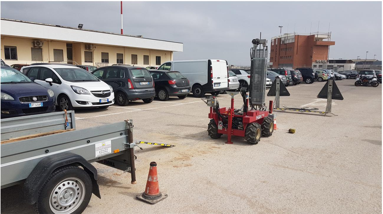
**Fig. 1: Particolare esecuzione prova penetrometrica dinamica P1 – parcheggio aerostazione**
