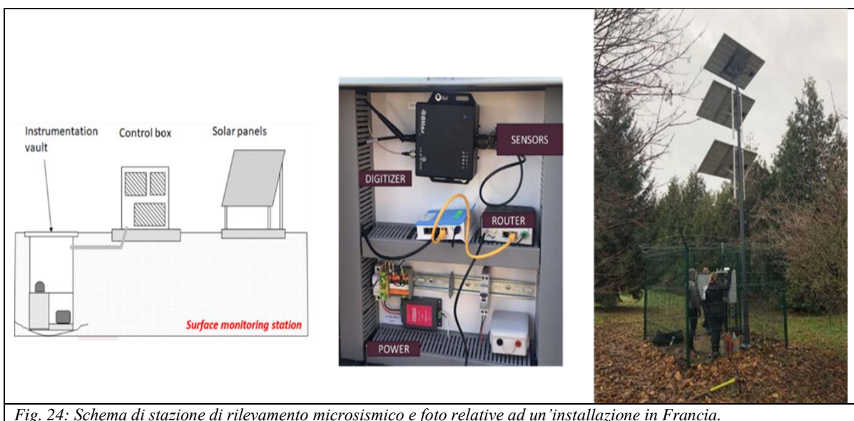
Fig. 24: Schema di stazione di rilevamento microsismico e foto relative ad un'installazione in Francia.
