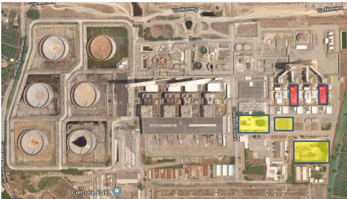
Figura 3.4.1 – Individuazione delle aree di cantiere e delle unità da sostituire
