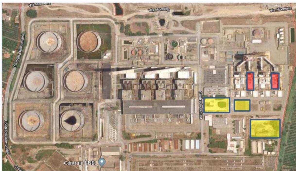
**Figura 4.3.11– Ortofoto della centrale di Rossano con indicazione dei gruppi da sostituire (in rosso) e l'area di cantiere (in giallo)**
