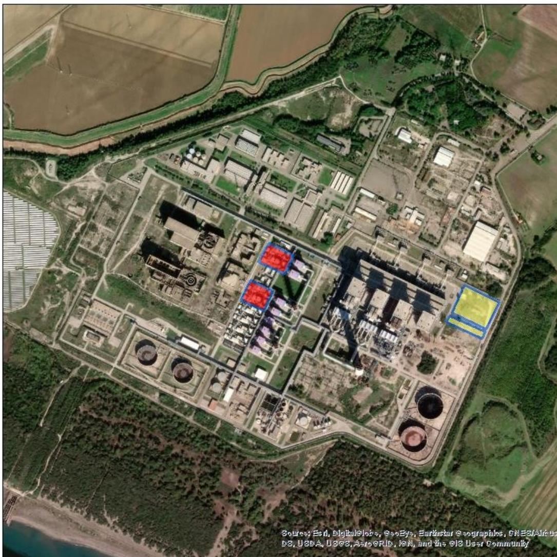
**Figura 4.3-6– Ortofoto della centrale di Montalto di Castro con indicazione dei gruppi da sostituire (in rosso) e l’area di cantiere (in giallo)**
