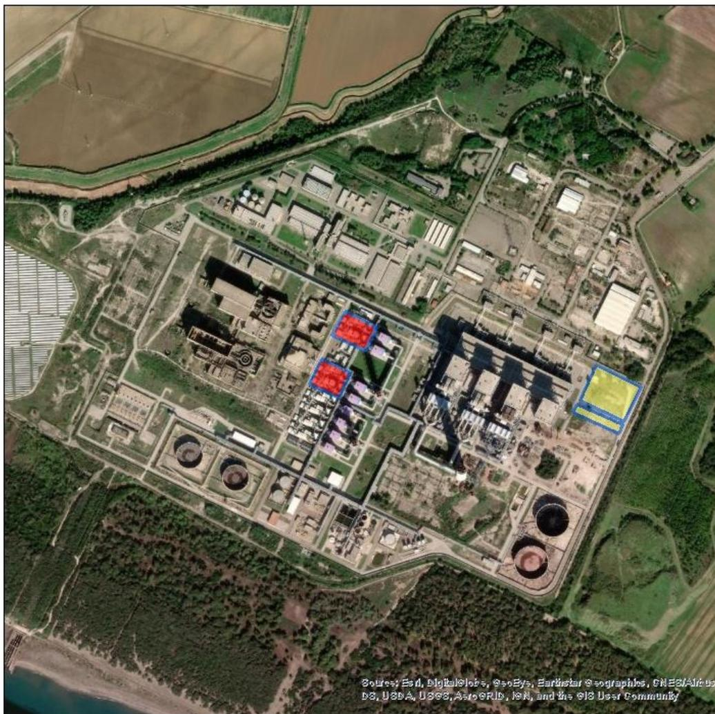
Figura 3.4-1 – Ortofoto della centrale con indicazione dei gruppi da sostituire (in rosso)
