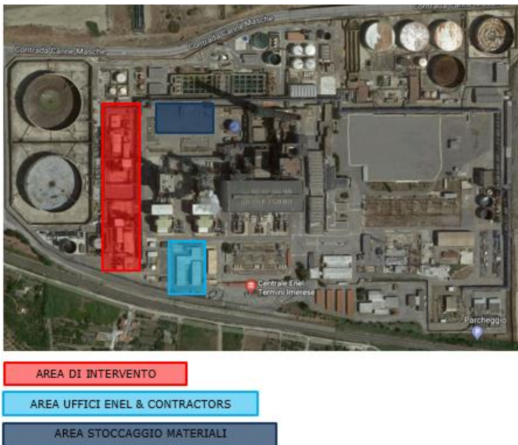
Figura 2.2 – Ortofoto della centrale di Termini con indicazione dei gruppi da sostituire (in rosso)
