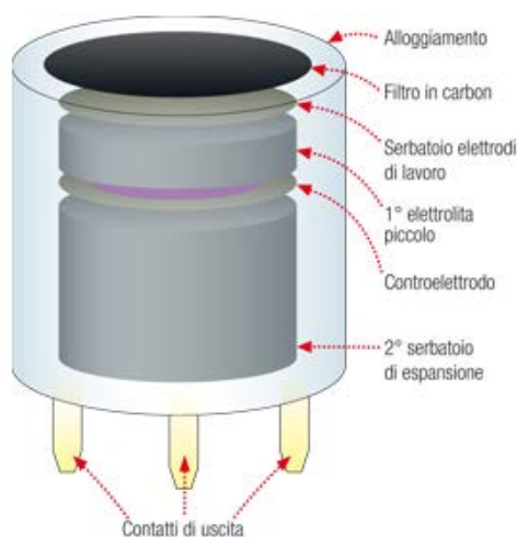
Figura 10.5: Cella Elettrochimica per misura Ossigeno
