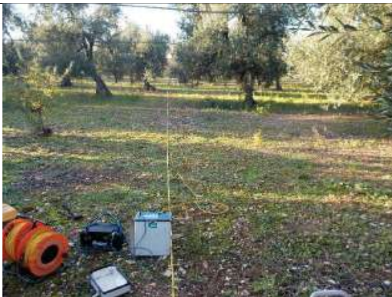
ERT.26, con p.to di vista dell'elettrodo E24 e particolare della strumentazione
