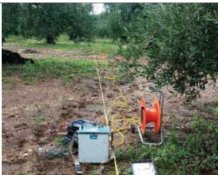
ERT.09, con p.to di vista dell'elettrodo E24 e particolare della strumentazione
