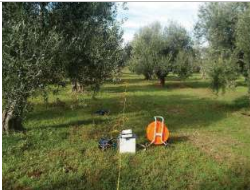
ERT.36, con p.to di vista dell'elettrodo E24 e particolare della strumentazione
