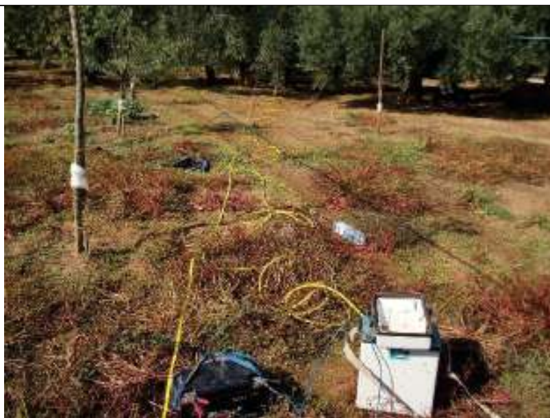
ERT.21, con p.to di vista dell'elettrodo E24 e particolare della strumentazione
