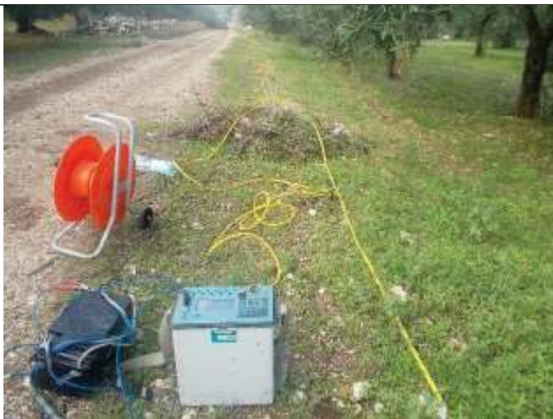
ERT.11, con p.to di vista dell'elettrodo E24 e particolare della strumentazione
