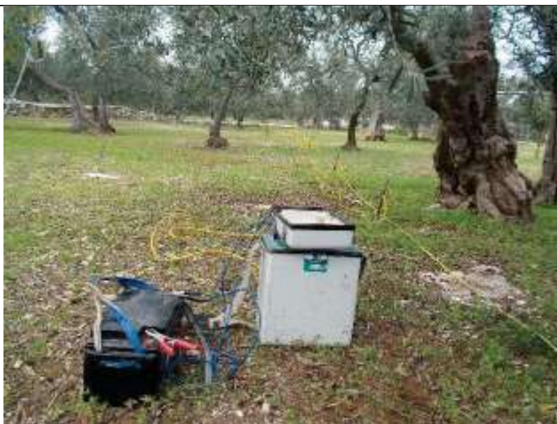
ERT.37, con p.to di vista dell'elettrodo E24 e particolare della strumentazione
