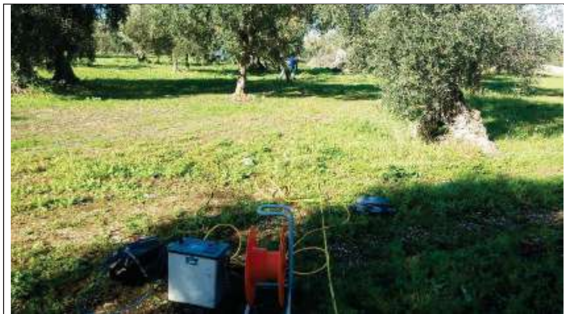
ERT.41, con p.to di vista dell'elettrodo E24 e particolare della strumentazione
