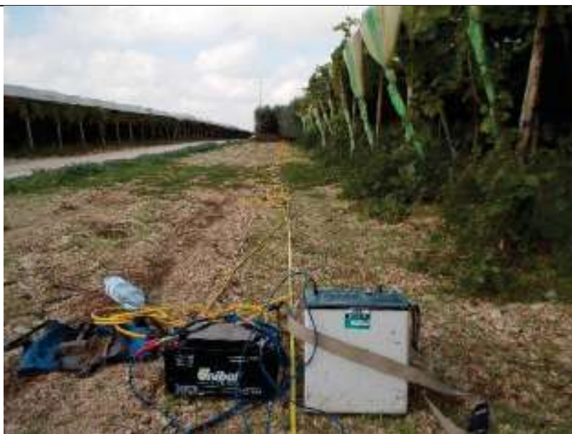
ERT.20, con p.to di vista dell'elettrodo E24 e particolare della strumentazione
