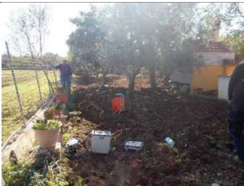
ERT.34, con p.to di vista dell'elettrodo E24 e particolare della strumentazione
