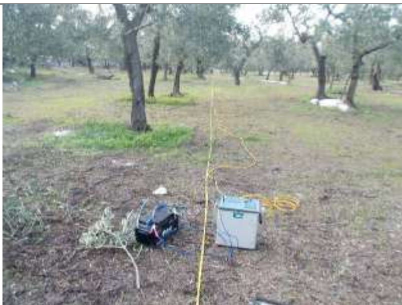
ERT.29, con p.to di vista dell'elettrodo E24 e particolare della strumentazione
