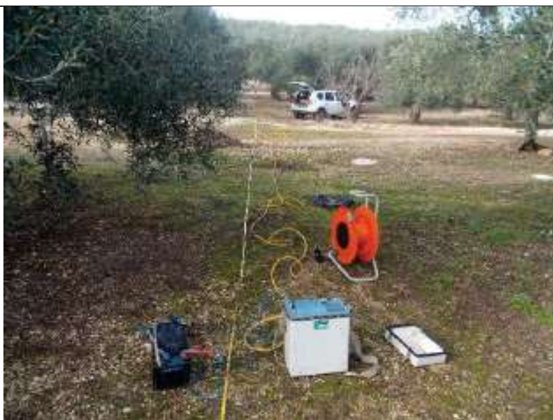
ERT.30, con p.to di vista dell'elettrodo E24 e particolare della strumentazione
