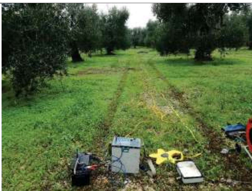
ERT.07, con p.to di vista dell'elettrodo E24 e particolare della strumentazione
