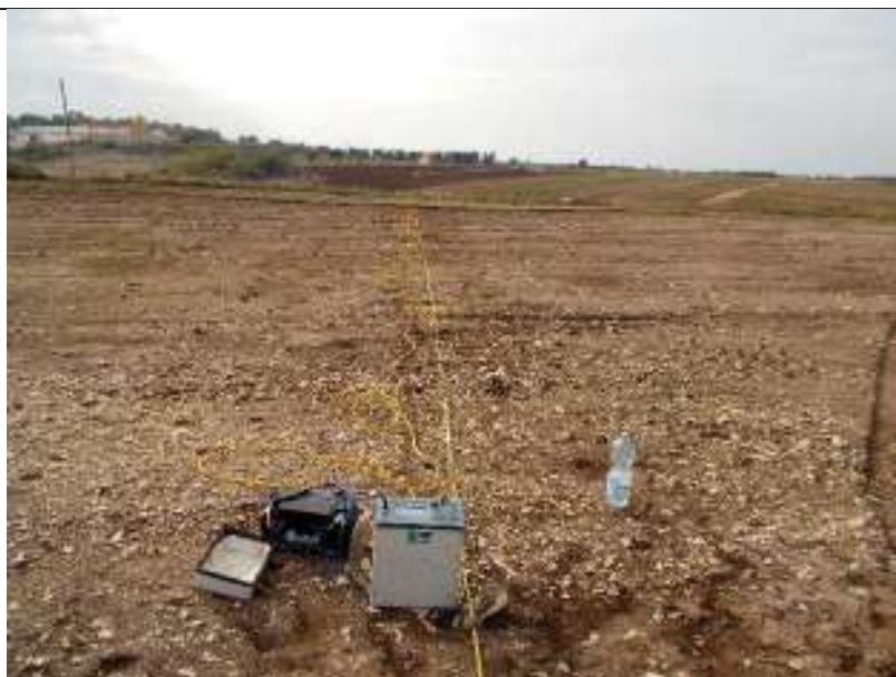
ERT.03, con p.to di vista dell'elettrodo E24 e particolare della strumentazione
