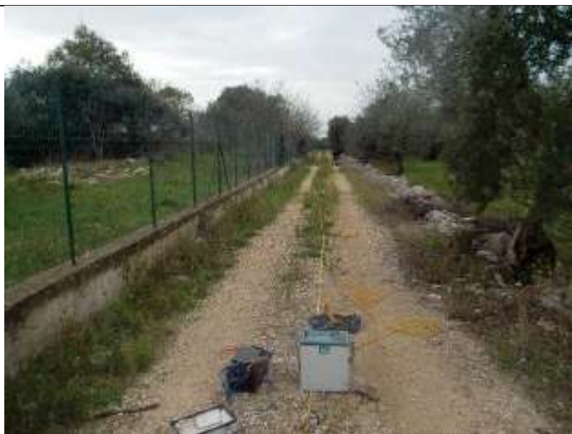
ERT.32, con p.to di vista dell'elettrodo E24 e particolare della strumentazione
