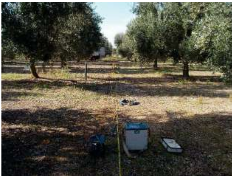
ERT.24, con p.to di vista dell'elettrodo E24 e particolare della strumentazione
