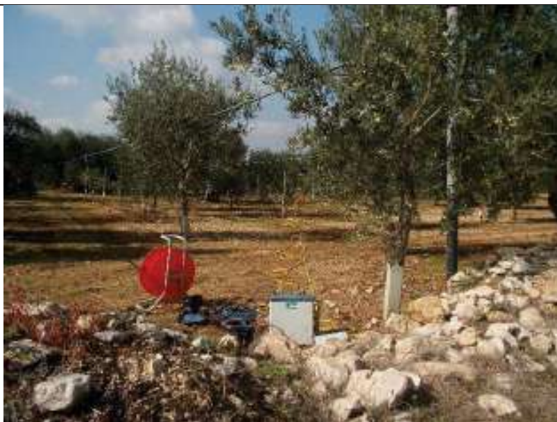
ERT.21, con p.to di vista dell'elettrodo E24 e particolare della strumentazione
