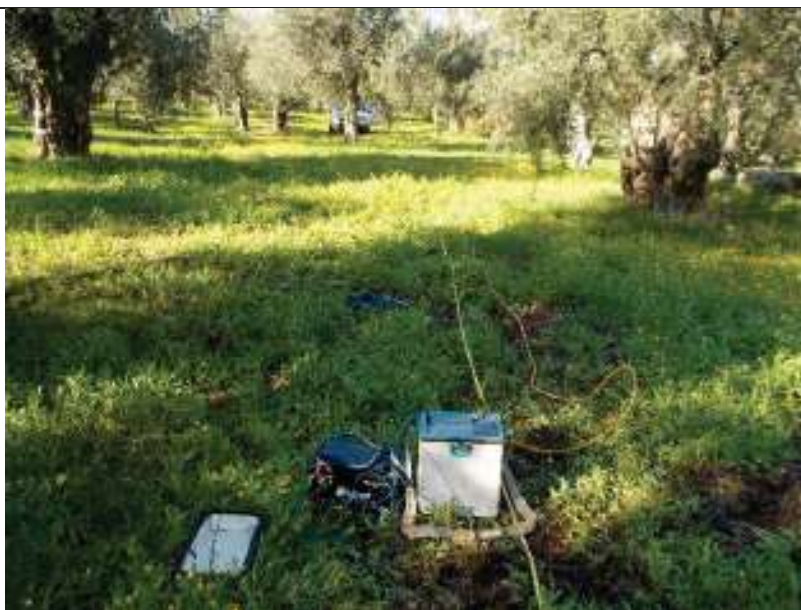
ERT.33, con p.to di vista dell'elettrodo E24 e particolare della strumentazione
