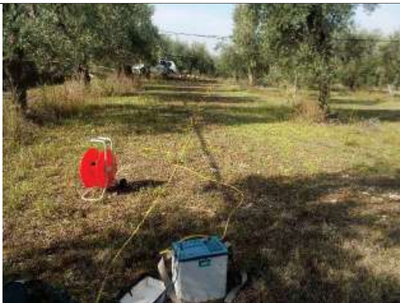
ERT.16, con p.to di vista dell'elettrodo E24 e particolare della strumentazione
