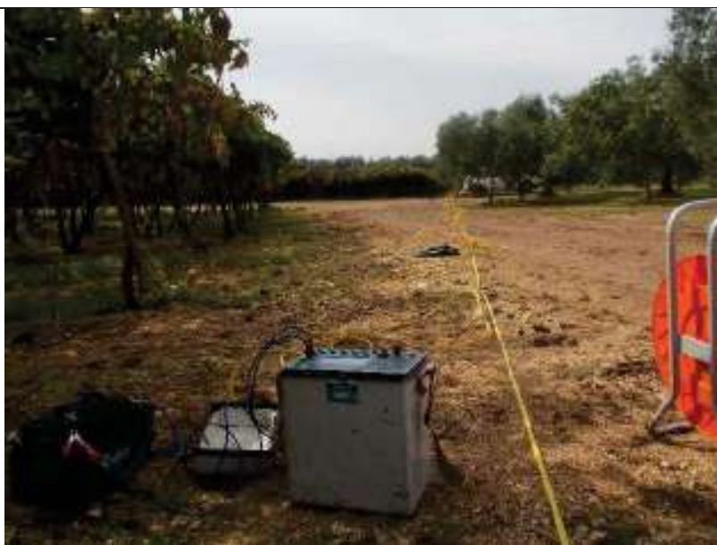
ERT.15, con p.to di vista dell'elettrodo E24 e particolare della strumentazione
