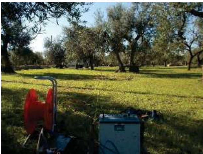
ERT.12, con p.to di vista dell'elettrodo E24 e particolare della strumentazione
