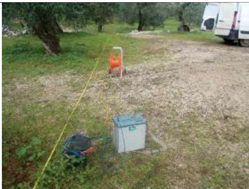
ERT.31, con p.to di vista dell'elettrodo E24 e particolare della strumentazione
