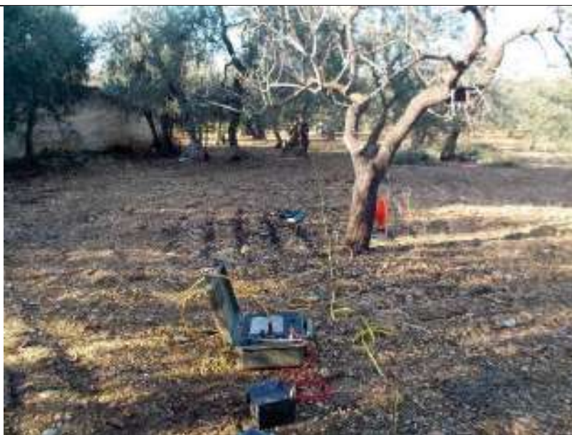
ERT.52, con p.to di vista dell'elettrodo E24 e particolare della strumentazione
