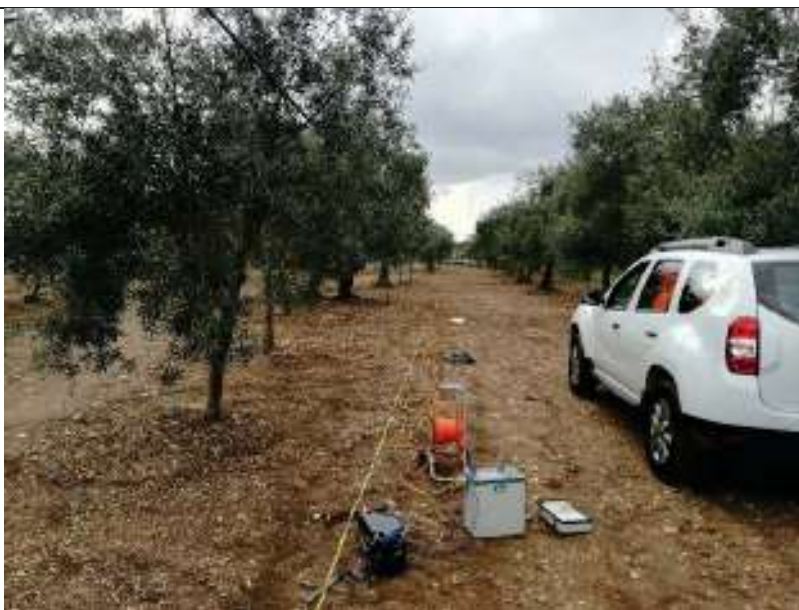
ERT.50, con p.to di vista dell'elettrodo E24 e particolare della strumentazione
