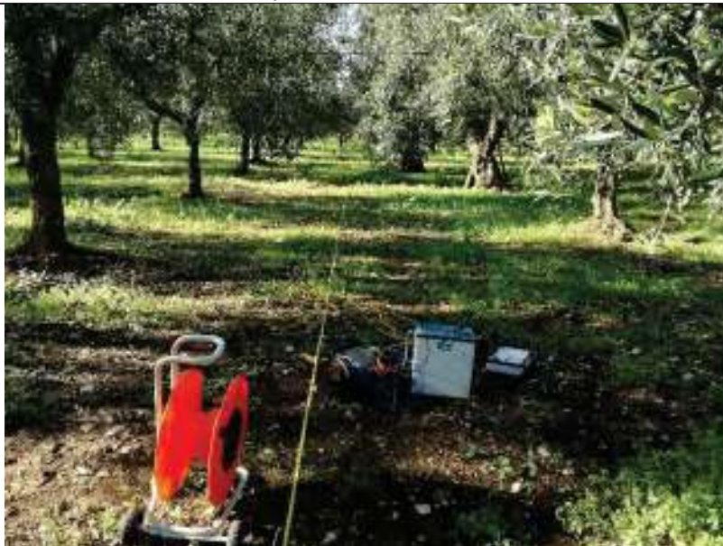
ERT.45, con p.to di vista dell'elettrodo E24 e particolare della strumentazione
