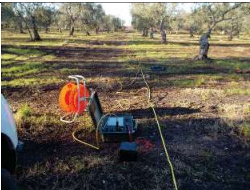
ERT.55, con p.to di vista dell'elettrodo E24 e particolare della strumentazione
