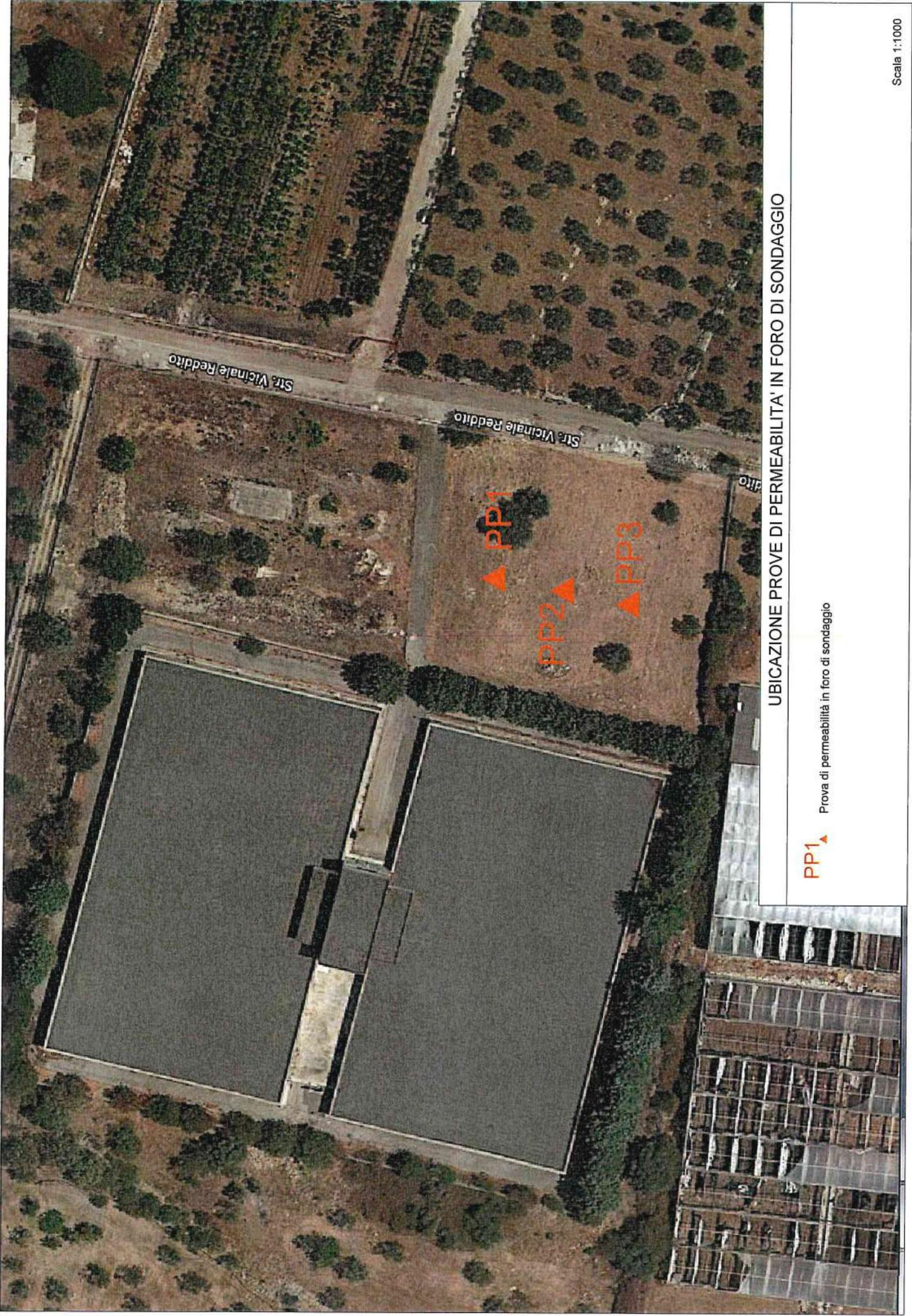
UBICAZIONE PROVE DI PERMEABILITA' IN FORO DI SONDAGGIO
