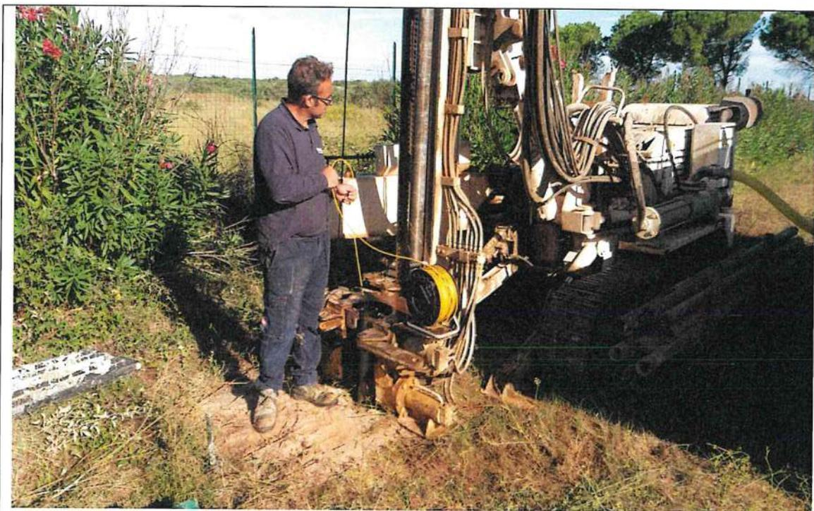
*Esecuzione prova Lefranc a carico variabile in abbassamento (Sondaggio S2)*
