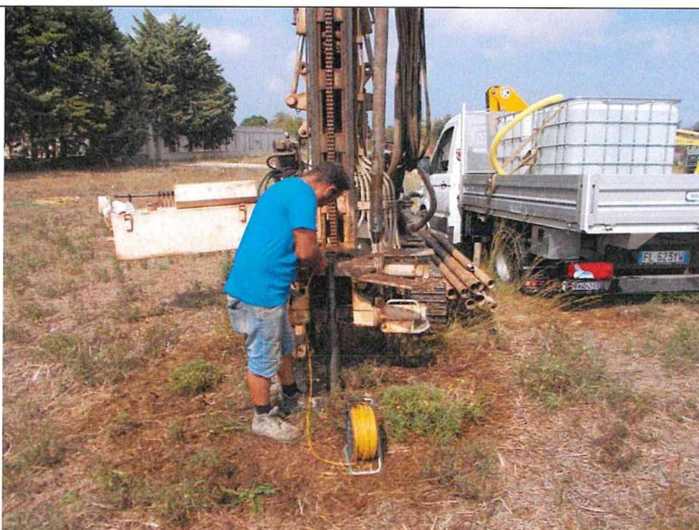
*Esecuzione prova Lefranc a carico variabile in abbassamento (Sondaggio S2)*
