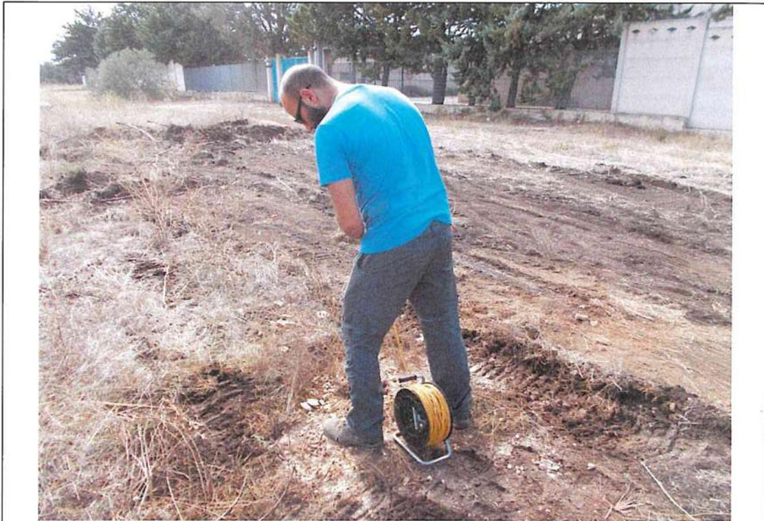
*Esecuzione prova Lefranc a carico variabile in abbassamento (Sondaggio S2)*
