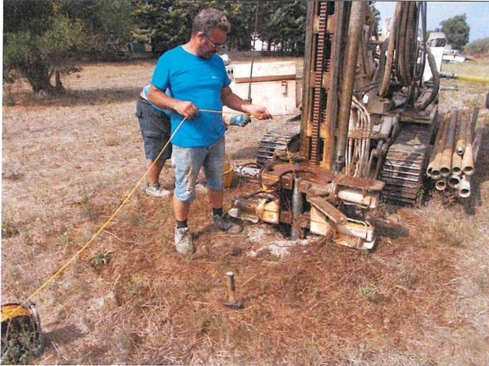
*Esecuzione prova Lefranc a carico variabile in abbassamento (Sondaggio S3)*
