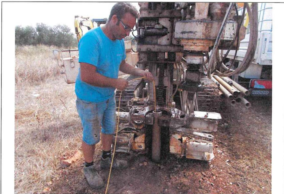
*Esecuzione prova Lefranc a carico variabile in abbassamento (Sondaggio S3)*
