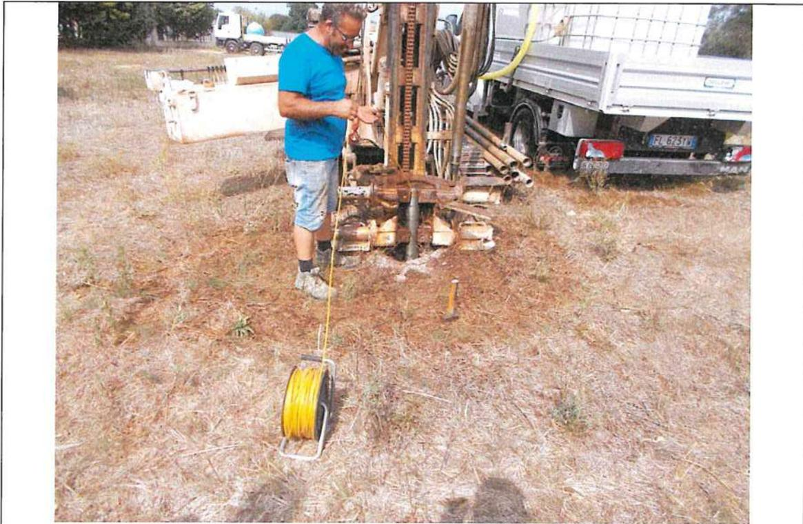
*Esecuzione prova Lefranc a carico variabile in abbassamento (Sondaggio S3)*
