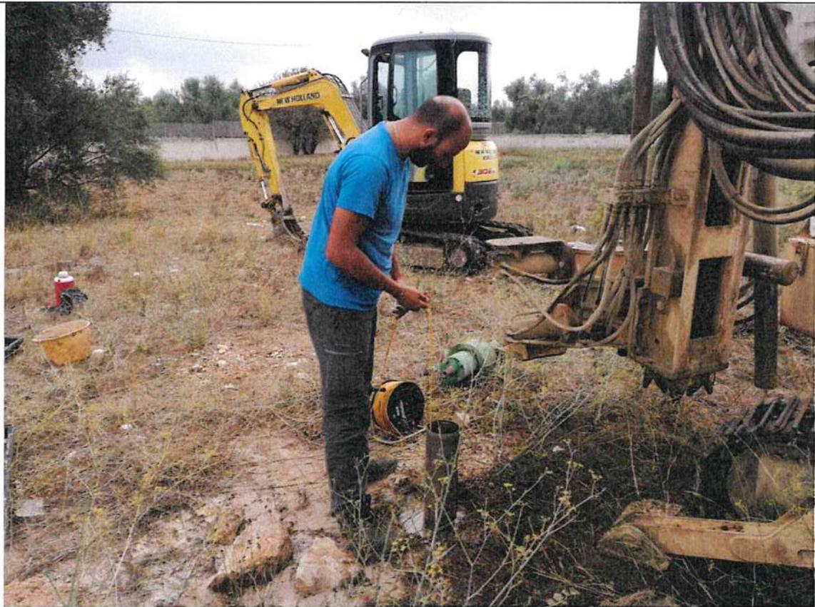
*Esecuzione prova Lefranc a carico variabile in abbassamento (Sondaggio S1)*
