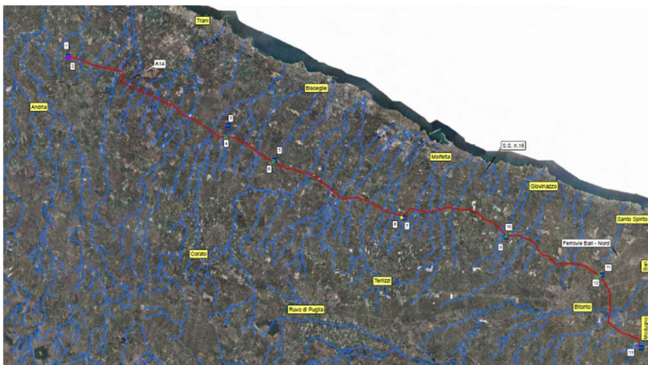
Figura 5.1 – Individuazione del reticolo secondario interessato dal tracciato in progetto
