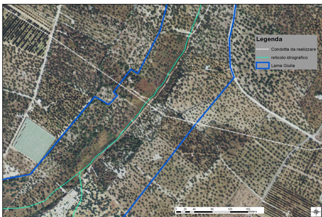
Figura 5.8 - punto di attraversamento di lama di Giulia
