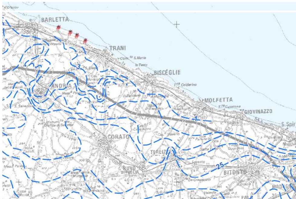
Figura 5.5 – Stralcio della Tav. 6.2 del Piano di Tutela delle Acque della Regione Puglia (distribuzione media dei carichi piezometrici degli acquiferi carsici della Murgia e del Salento), scala originale 1:200.000. Sono rappresentate le linee isopiezometriche con quota in m.s.l.m.
