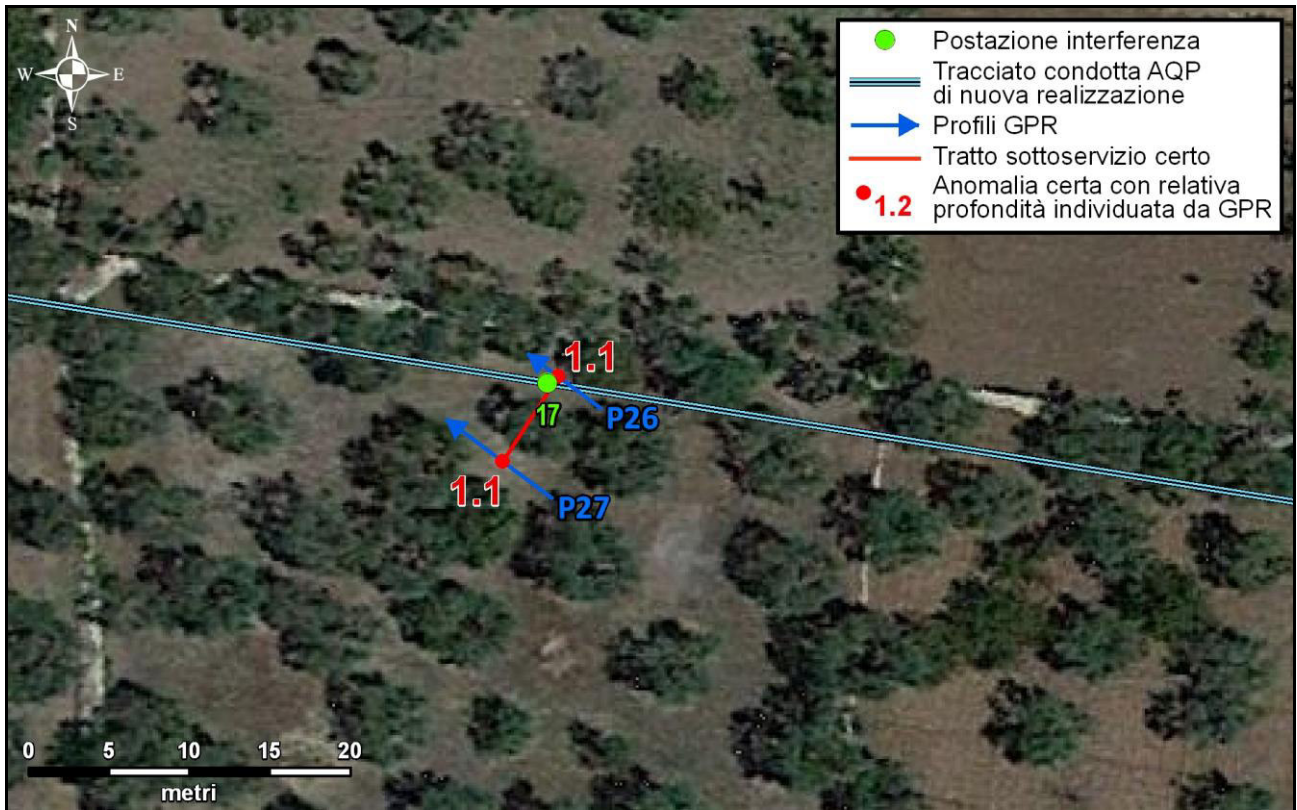
Figura 62 – Planimetria della postazione di interferenza num.17 con indicazione dei sottoservizi individuati o presunti e delle profondità dei segnali.
