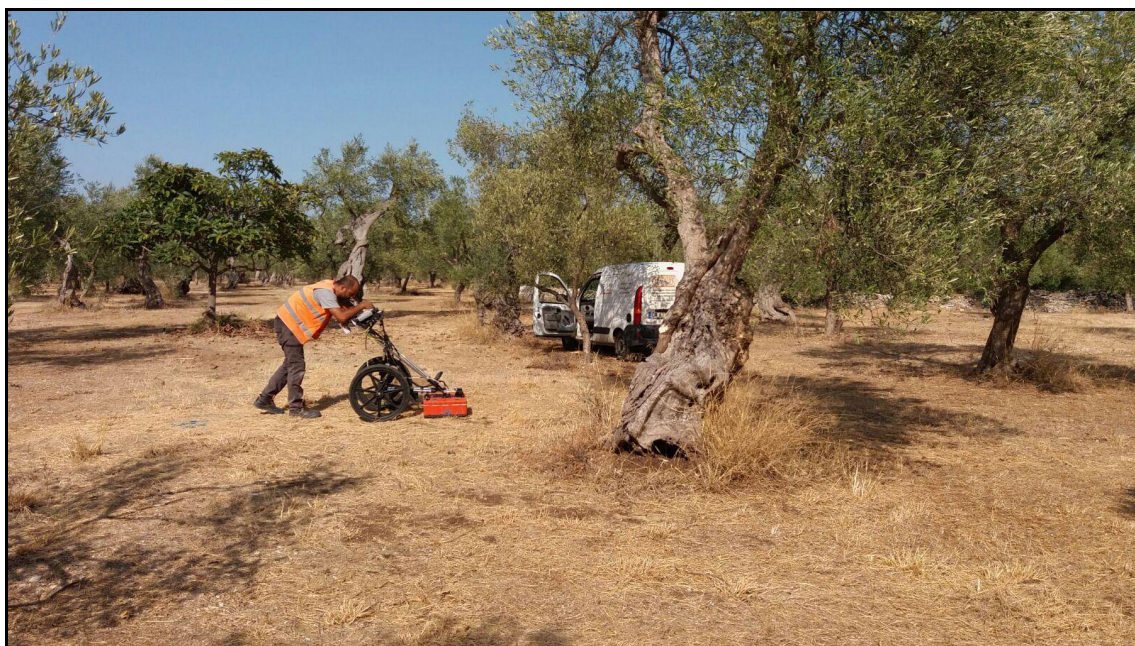
Foto 4 - Acquisizione georadar profilo P32, postazione interferenza num 14.
