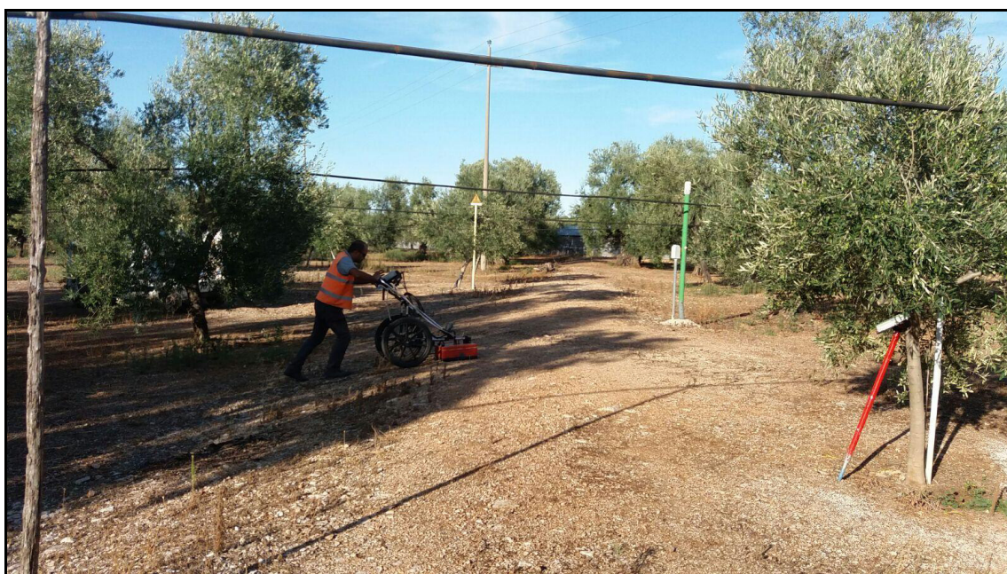
Foto 2 - Acquisizione georadar profilo P72, postazione interferenza num 7.
