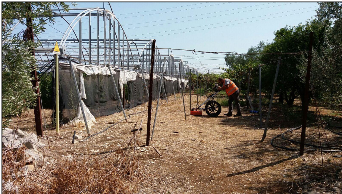
Foto 5 - Acquisizione georadar profilo P24, postazione interferenza num 18.
