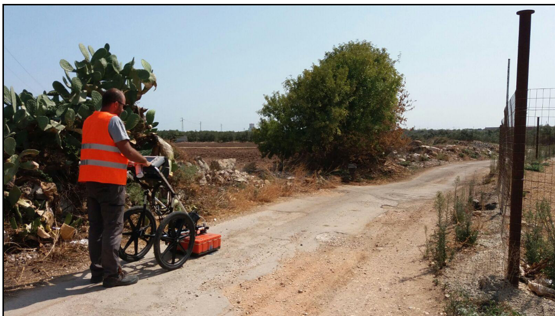
Foto 6 - Acquisizione georadar profilo P4, postazione interferenza num 25.
