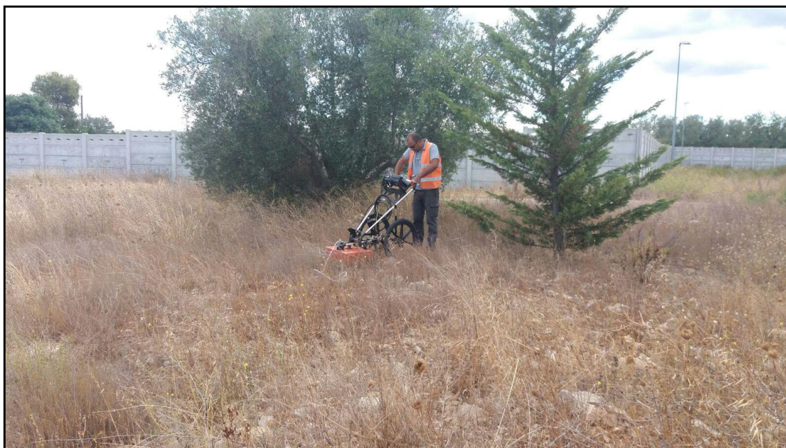
Foto 1 - Acquisizione georadar profilo P57, postazione interferenza num 1.
