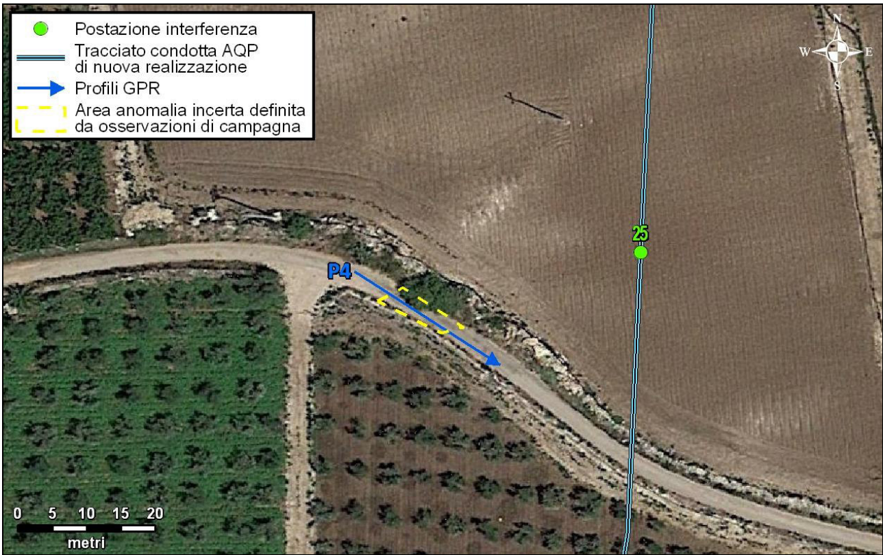
Figura 97 – Planimetria della postazione di interferenza num.25 con indicazione dei sottoservizi individuati o presunti e delle profondità dei segnali.
