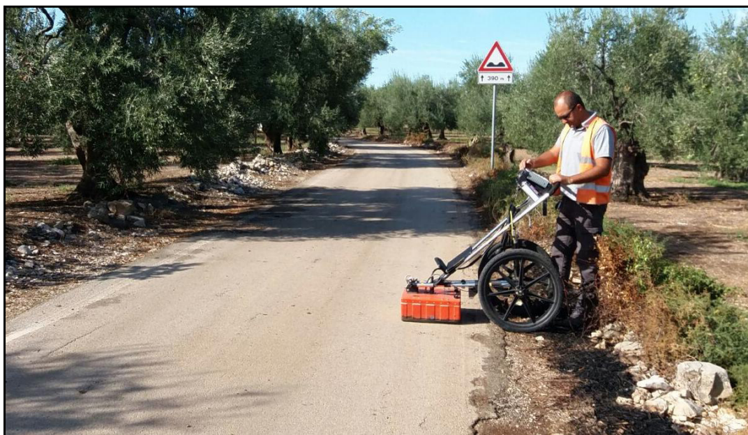
Figura 3 – Configurazione strumentale utilizzata con relativa antenna.
