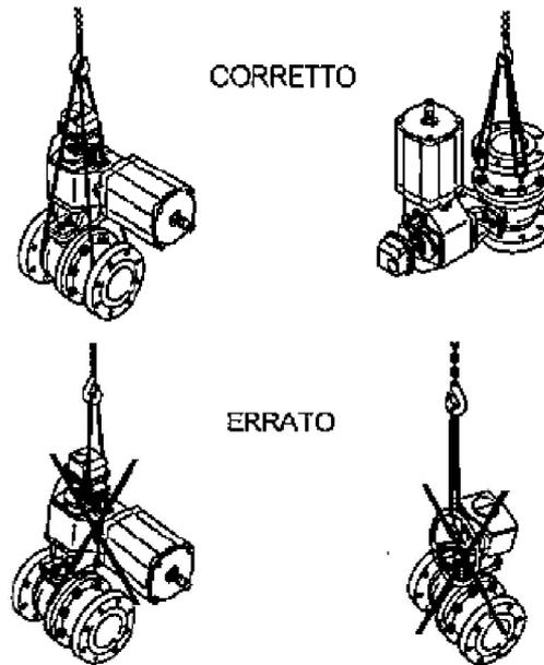
*Sollevamento della valvola* Il sollevamento e lo spostamento delle valvole (con l'attuatore già montato) durante l'installazione deve essere eseguito in accordo con le istruzioni dei precedenti punti e non deve avvenire mai tramite l'attuatore elettrico o il volantino di manovra ma bisogna servirsi degli eventuali golfari oppure delle flange.
