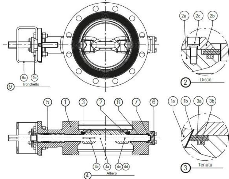
Le valvole saranno esclusivamente del tipo flangiato (non sono accettate valvole tipo wafer o lug) con la seguente funzione:
