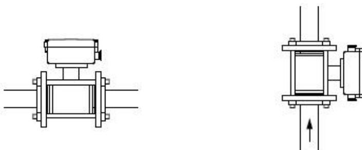
Dovendolo installare in orizzontale, bisogna assicurarsi che gli elettrodi di misura si trovino su un piano orizzontale per evitare che eventuali depositi sul fondo o aria nella parte alta della sezione di misura possano isolare gli elettrodi.
