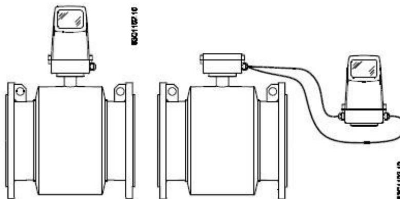
Il collegamento tra sensore e convertitore nella versione separata può essere eseguito con cavi standard e non aventi caratteristiche specifiche dettate dal costruttore. La lunghezza dei cavi, funzione della conducibilità del liquido, deve poter coprire distanze fino a 500m.
