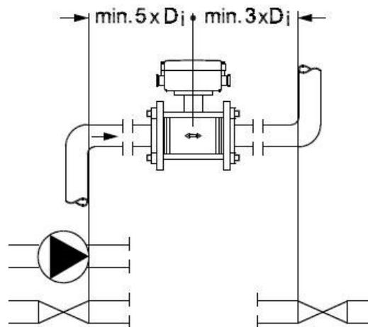
In presenza di vortici e forti turbolenze occorre allungare le sezioni di ingresso e di uscita, oppure installare dei raddrizzatori di flusso.
