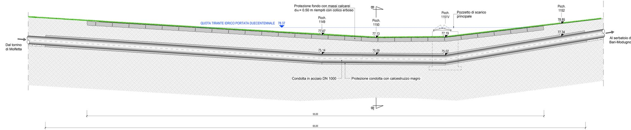
**POZZETTO DI SCARICO PRINCIPALE CON RESTITUZIONE IN ALVEO**
