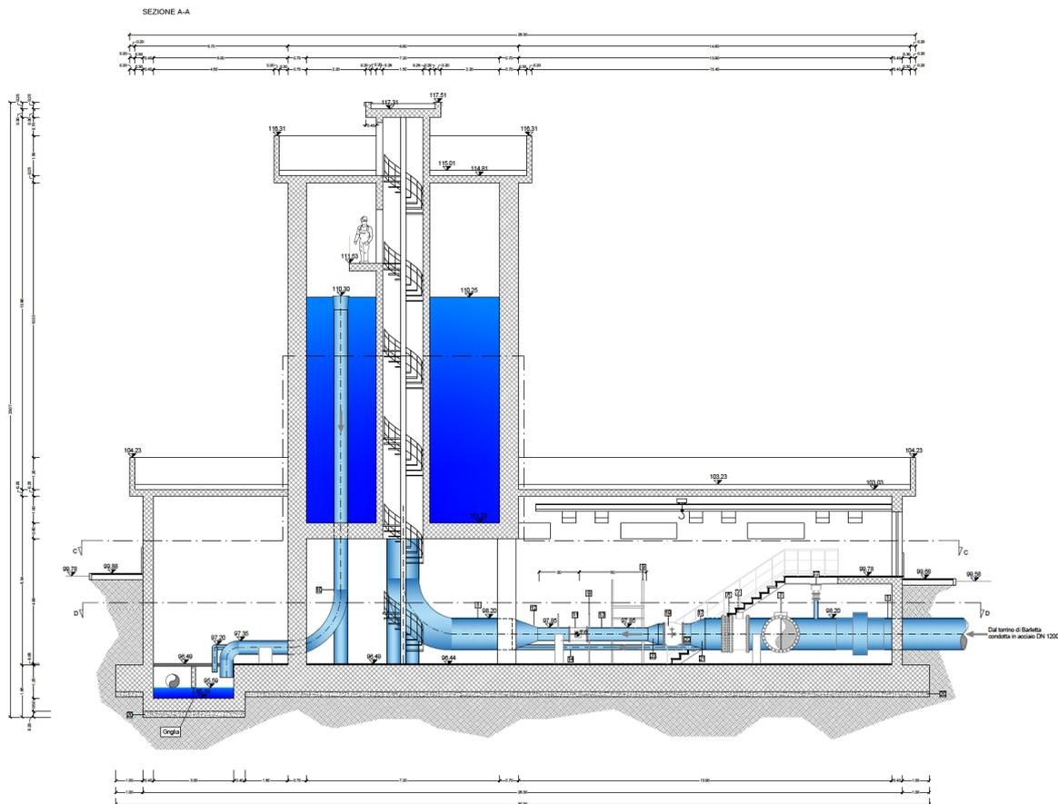
Figura 2.10 – Sezione torrino piezometrico
