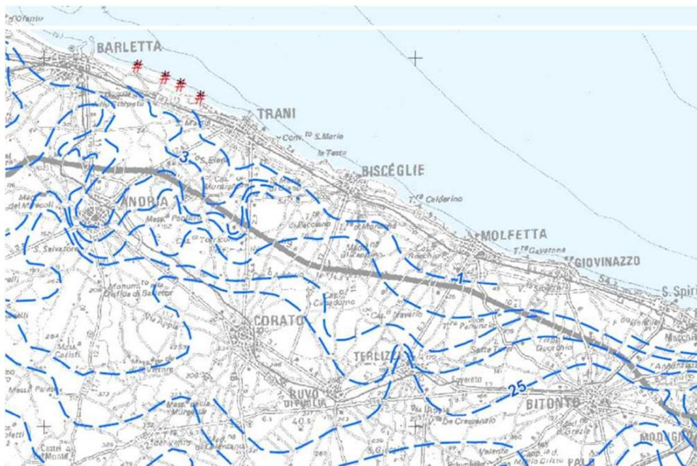
Figura 3.5 – Stralcio della Tav. 6.2 del Piano di Tutela delle Acque della Regione Puglia (distribuzione media dei carichi piezometrici degli acquiferi carsici della Murgia e del Salento), scala originale 1:200.000. Sono rappresentate le linee isopiezometriche con quota in m.s.l.m.
